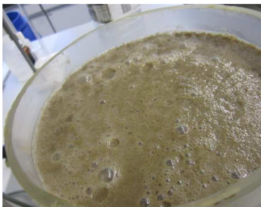
Figura 12 – Formações gasosas no seio do sobrenadante em ensaio de decantabilidade
