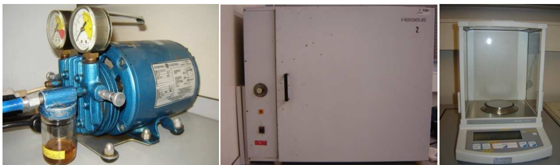
Figura 20 - Equipamento utilizado na análise de MLSS: bomba de vácuo ( General Electric Modelo 5KH33EN25T), estufa (T-122 da Heraeus ) e balança analítica (modelo 120-4 da marca KERN ABS )
