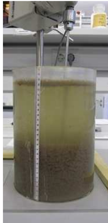
Figura 41 – Lama sedimentada com tendência a compactar aos 9 minutos de ensaio e registo de uma camada de sobrenadante com bolhas de gás, sem ocorrência de ascensão de flocos (2011/04/01)
