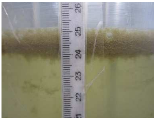
Figura 42 – Aspecto da fina camada de sobrenadante com pequenas bolhas de gás no minuto 11 de ensaio (2011/04/01)
