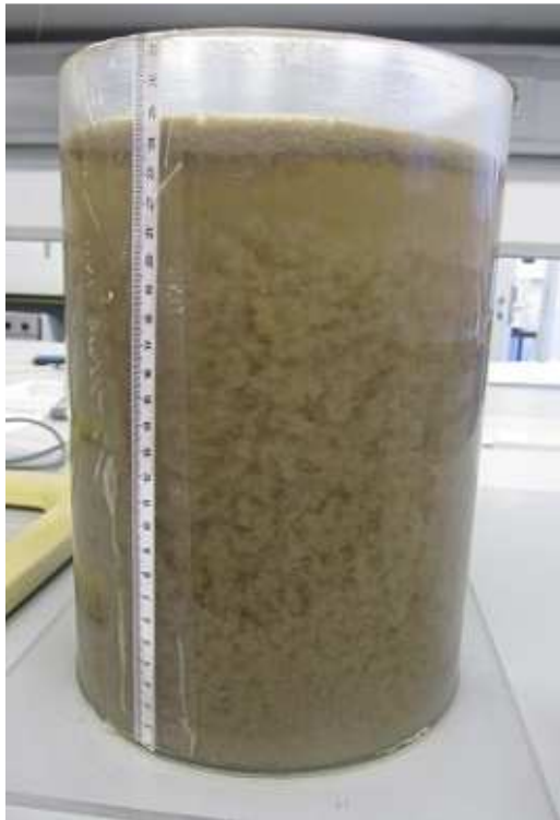
Figura 40 – Formação de flocos (com aspecto de nuvens) e tendência de sedimentação no início do ensaio sem agitação (2011/04/01)
