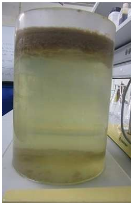
Figura 45 – Efluente bastante clarificado, em lamas ascensionais com presença de alguns flocos no fundo (2011/04/01)
