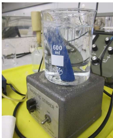
Figura 26 – Saturação de água para calibração da sonda YSI 5905 BOD Probe para análise de SOUR
