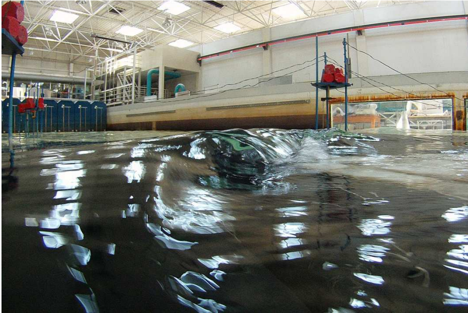
Fig. 5.32 – Vista do tubo na Série I / Ensaio 1, Teste 56 (CM=0.8m (Z.H.), H=1.5m, T=11seg).
