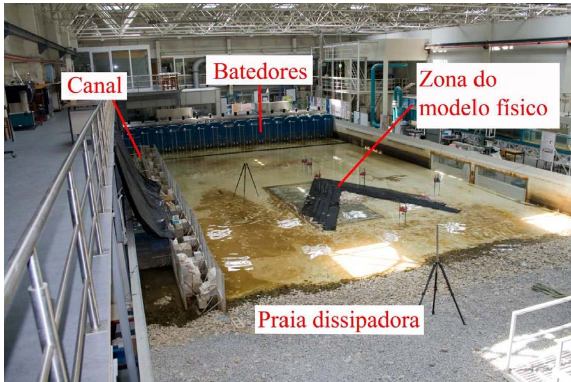
Fig. 5.5 – Tanque de ondas.
