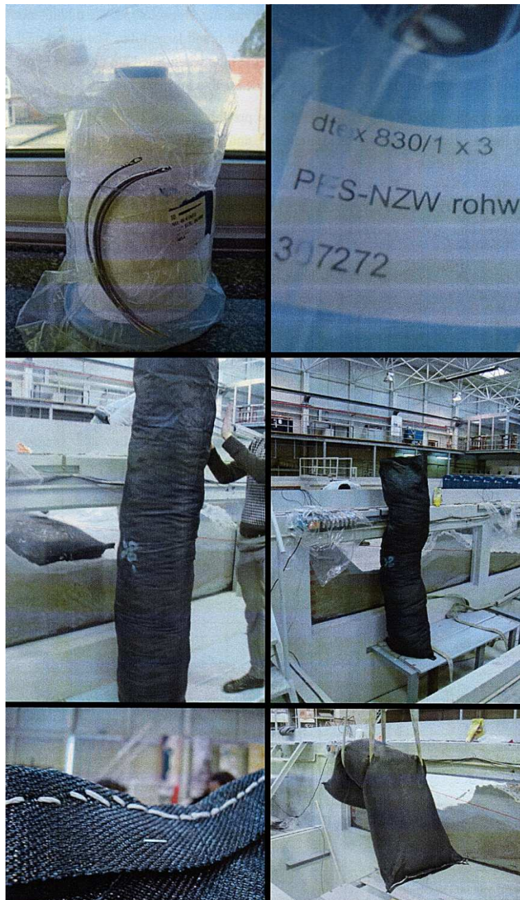
Fig. 5.3 – Aspectos do enchimento e costura dos Geotube® (das Neves, 2010).
