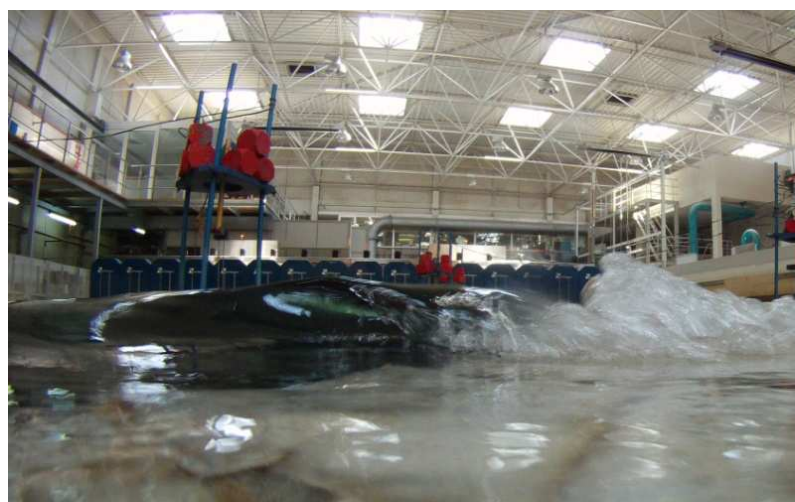
Figura 5.37 – Vista do interior do tanque, Série III / Ensaio 1, Teste 54 (CM=0.8m (Z.H.), H=1.5m, T=11seg).
