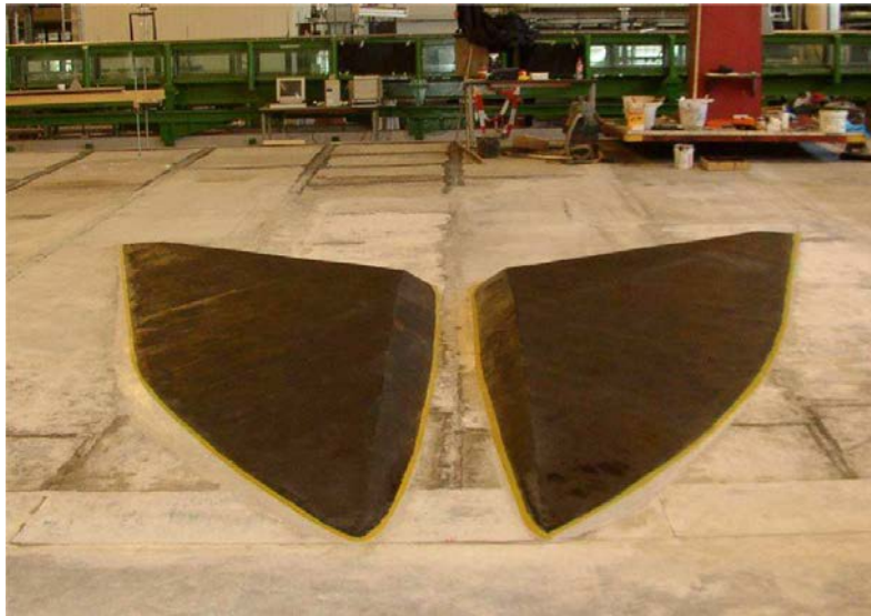
Fig. 3.1 – Modelo físico do recife ensaiado. (Cáceres et al , 2010).
