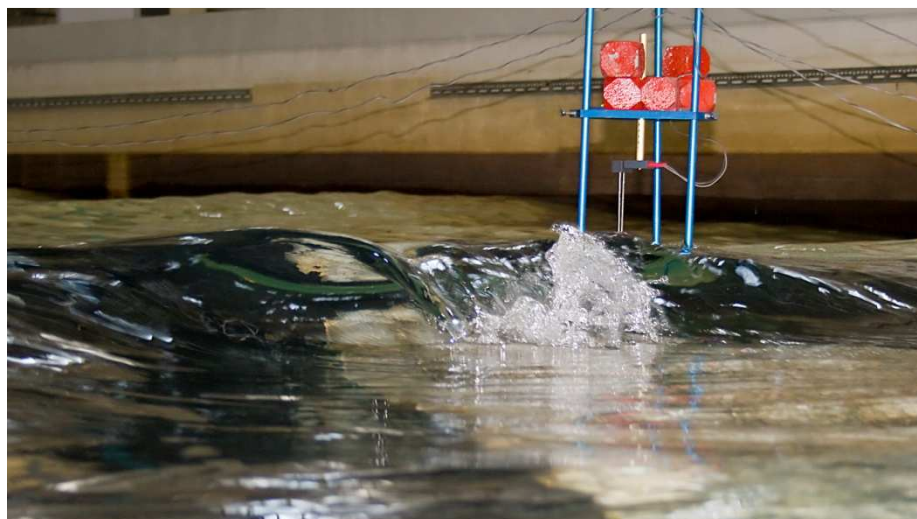
Fig. 2.4 – Onda “tubular” no ensaio em modelo físico (Laboratório de Hidráulica, FEUP).
