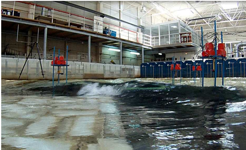
Figura 5.38 - Vista do interior do tanque, Série III / Ensaio 7, Teste 54 (CM=1.4m (Z.H.), H=3m, T=11seg).
