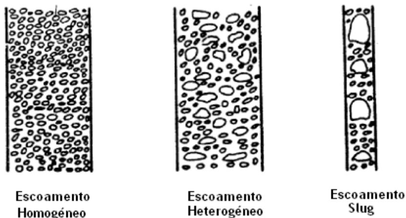
Figura 5 Regimes de escoamento mais comuns em colunas de borbulhamento (adaptado de Decker, (1992))
