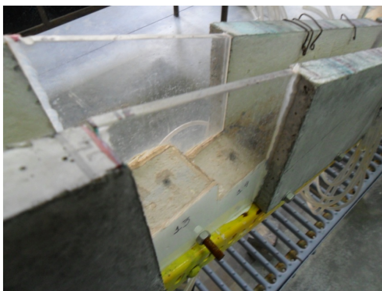
Fig. 3.3. – Pormenor de degraus no descarregador, na secção de largura constante
