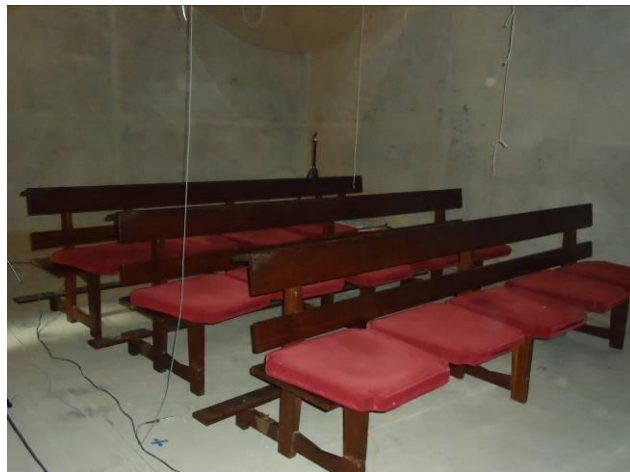
Fig. 4.24 – Bancos tipo A no ensaio com almofadas, no interior da câmara reverberante [foto da autora]
