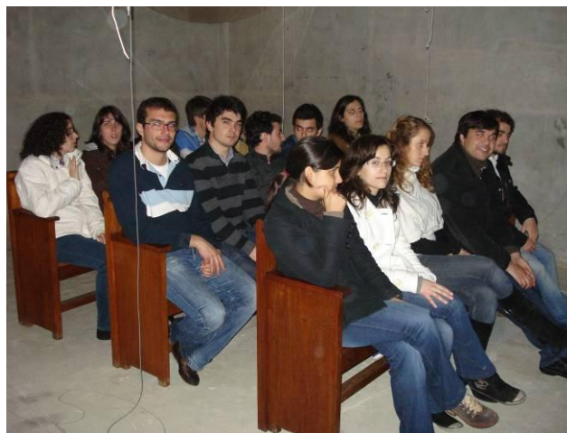
Fig. 4.21 – Bancos tipo F no ensaio com pessoas, no interior da câmara reverberante [foto de A. Costa]
