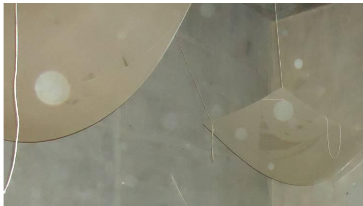
Fig. 4.3 – Difusores no interior da câmara reverberante R1 da FEUP [foto da autora]
