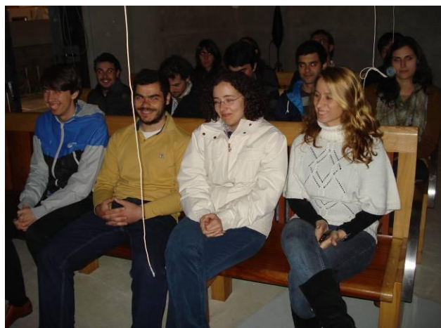
Fig. 4.22 – Bancos tipo N no ensaio com pessoas, no interior da câmara reverberante [foto de A. Costa]
