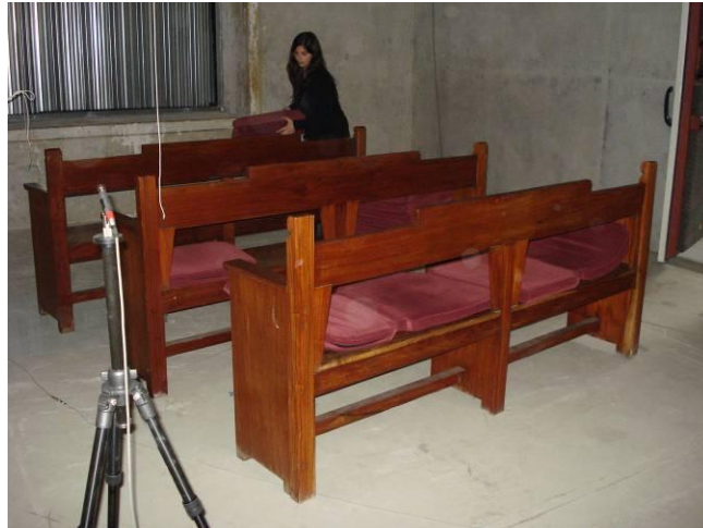
Fig. I.6 – Preparação do banco do tipo F para o ensaio com almofadas [foto do António E. Costa]
