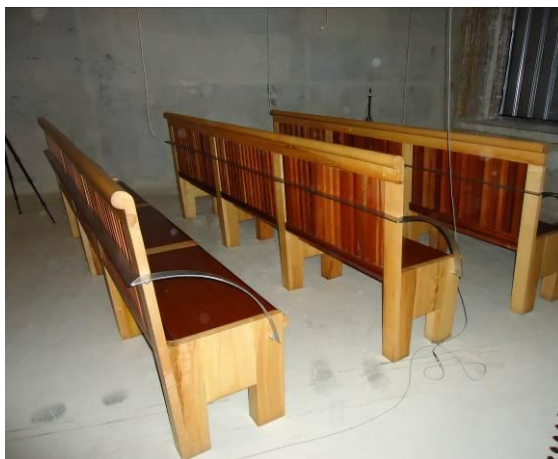
Fig. 4.17 – Disposição dos bancos tipo N no interior da câmara reverberante [foto da autora]
