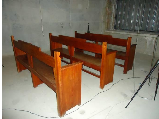
Fig. 4.13 – Disposição dos bancos tipo F no interior da câmara reverberante [foto da autora]
