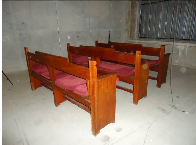
Fig. 4.23 – Bancos tipo F no ensaio com almofadas, no interior da câmara reverberante [foto da autora]
