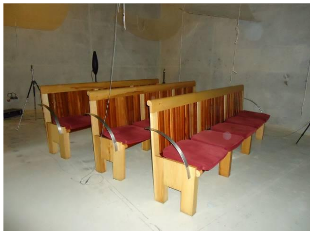
Fig. 4.25 – Bancos tipo N no ensaio com almofadas, no interior da câmara reverberante [foto da autora]
