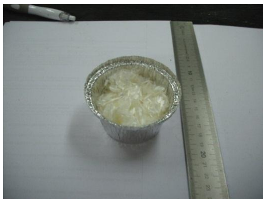
Fig. 2.26 – Fibras poliméricas utilizadas nos ensaios (LGMC, 2011)
