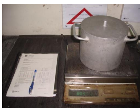
Fig. 4.11 – Picnômetro e balança (LGMC, 2011)
