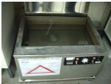
Fig. 4.15 – Fio suspenso ligado à balança para pesar o provete imerso em água (LGMC, 2011)
