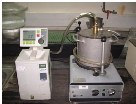
Fig. 4.9 – Mesa vibratória, sistema de vácuo e picnômetro (LGMC, 2011)
