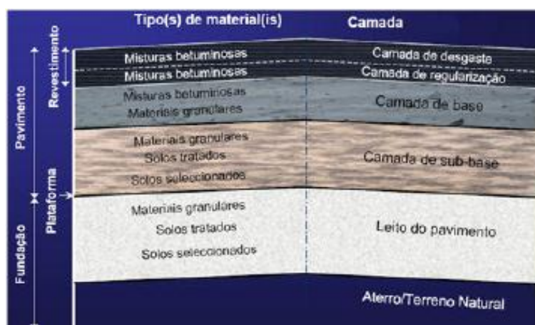
Fig. 2.4 – Estrutura de um pavimento flexível (Pavimentos Rodoviários, 2009)
