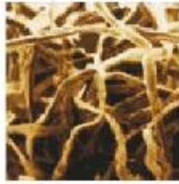
Fig. 2.27 – Fibras poliméricas sem ligante (SciELO, 2009)
