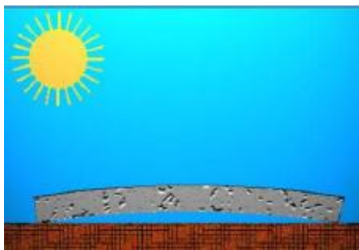
Fig. 2.11 – Empenamento no período diurno (Pavimentos rodoviários, 2009)
