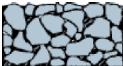
Fig. 3.3 – Esqueleto de uma mistura betuminosa SMA (Asphalt, 2006)
