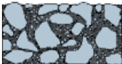
Fig. 3.4 – Esqueleto de uma mistura betuminosa convencional (Asphalt, 2006)
