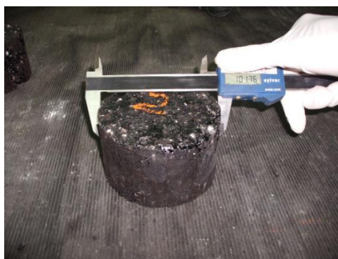
Fig. 4.17 – Determinação das dimensões do provete com o auxílio de um paquímetro (LGMC, 2011)
