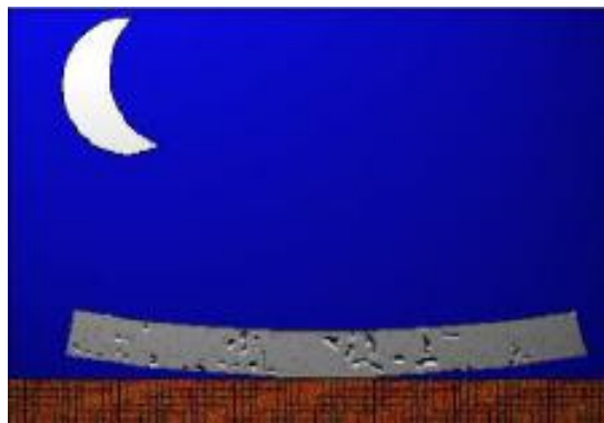
Fig. 2.12 – Empenamento no período noturno (Pavimentos rodoviários, 2009)
