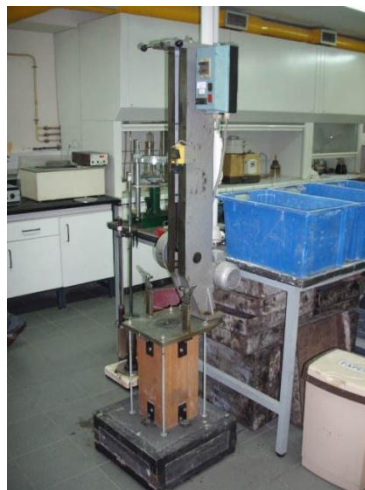
Fig. 4.16 – Compactador de impacto com pedestal de madeira (LGMC, 2011)
