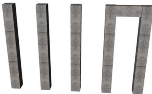
Figura 58 - Colocação de viga de pilar a pilar.
