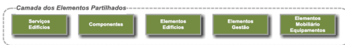
Figura 15 - Camada dos Elementos Partilhados do Modelo IFC 2x4. Adaptado de (Sousa et al. 2011).
