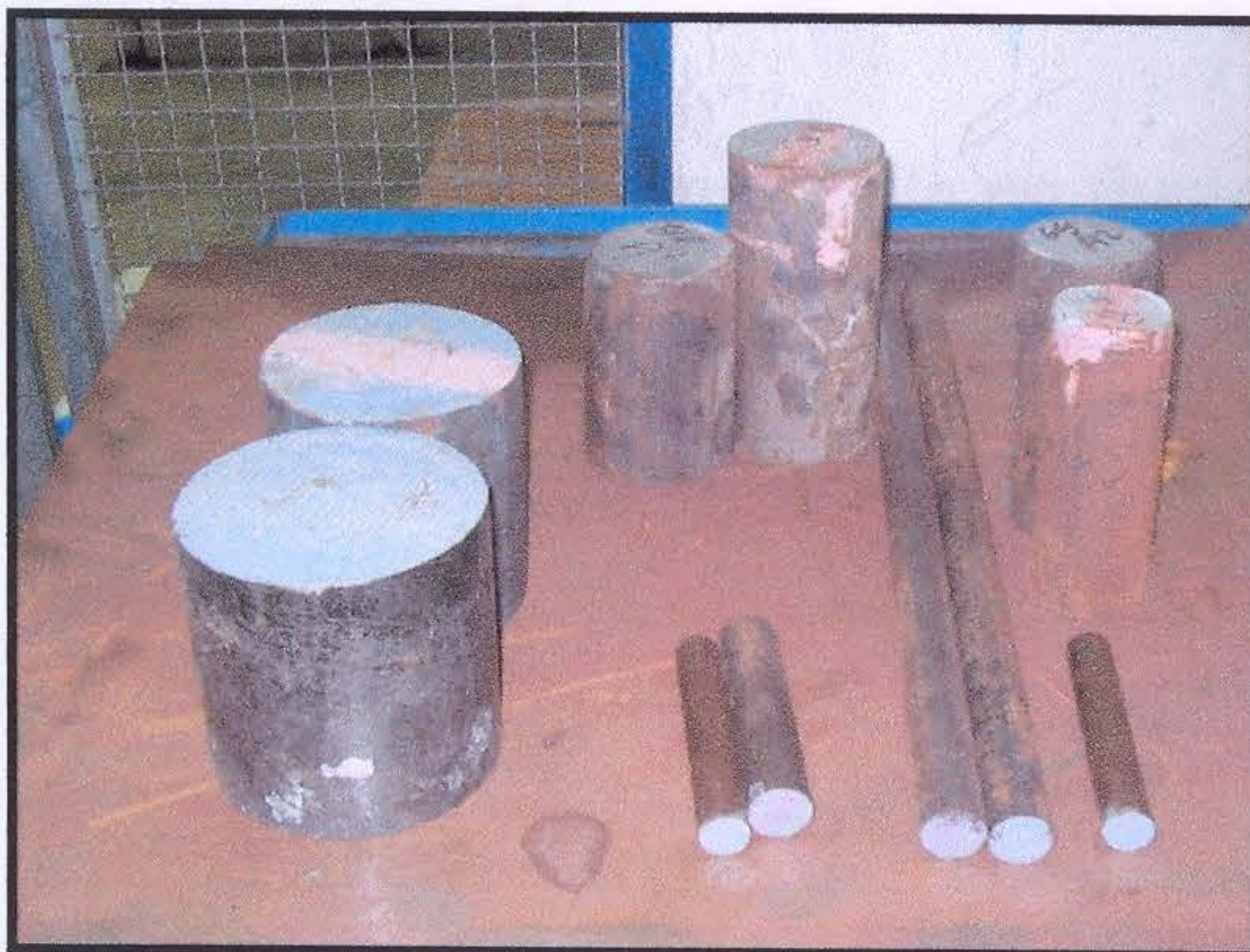
Figura 10 : Aspecto das amostras antes de serem torneadas (à esquerda), e após torneamento (à direita)
