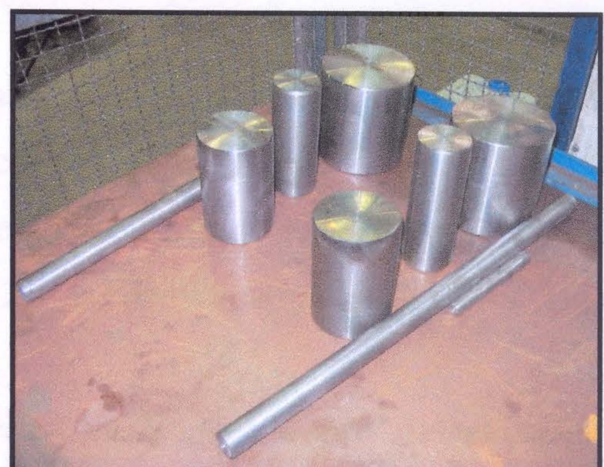
Figura 10 : Aspecto das amostras antes de serem torneadas (à esquerda), e após torneamento (à direita)
