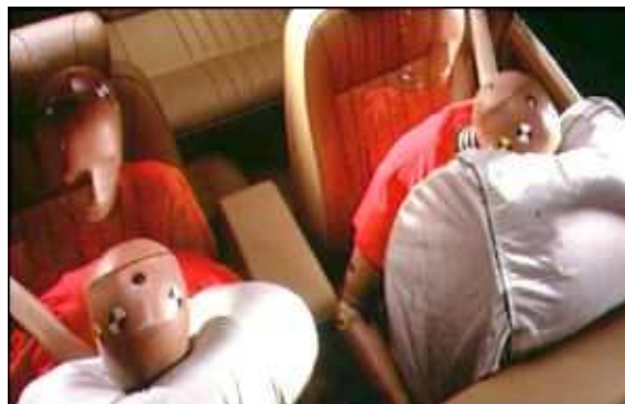
Figura 14 - Baixa pressão interna (contacto “ocupante-saco”)
