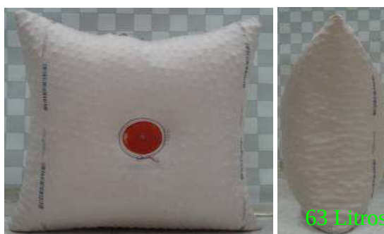
Figura 92 – Ensaio de volume do saco TJ11H
