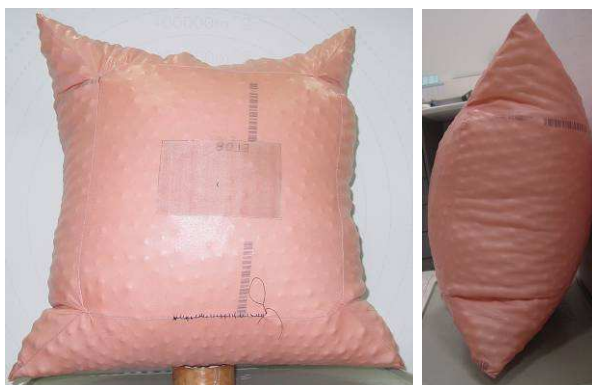
Figura 58 – Saco TJ08 cheio com bolas de 20mm de diâmetro
