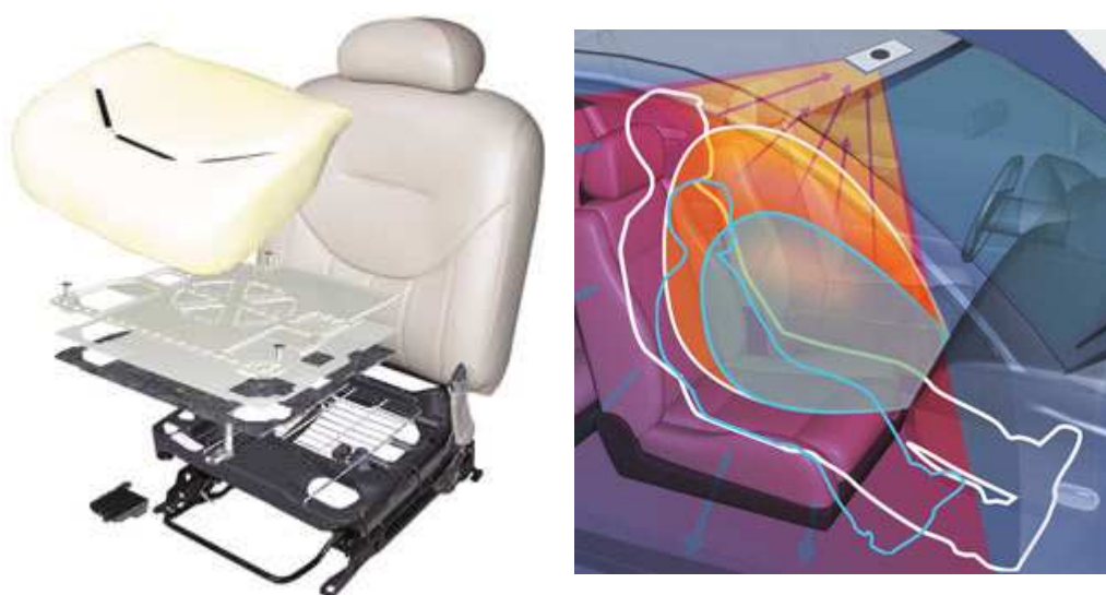
Figura 35 – Airbags inteligentes (detectam o peso do ocupante através de uma célula de carga ou sensor óptico)
