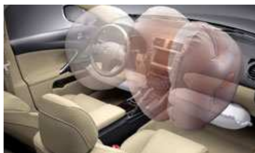
Figura 22 – airbag para protecção do joelho
