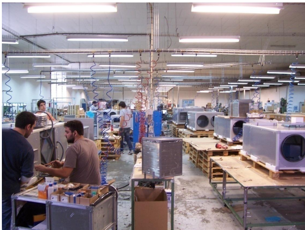
Figura 8 - Produção de recuperadores de calor em células individuais
