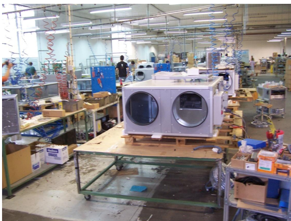
Figura 9 - Produção de recuperadores de calor em células individuais
