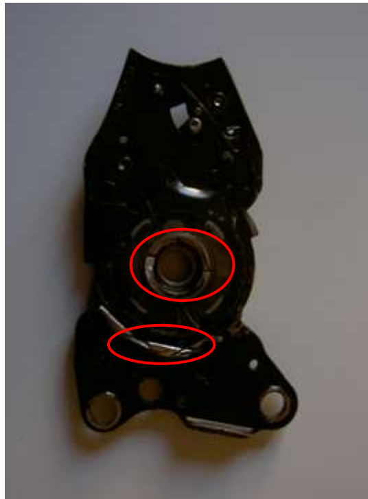
Fig. 54 – Danos causados durante o teardown
