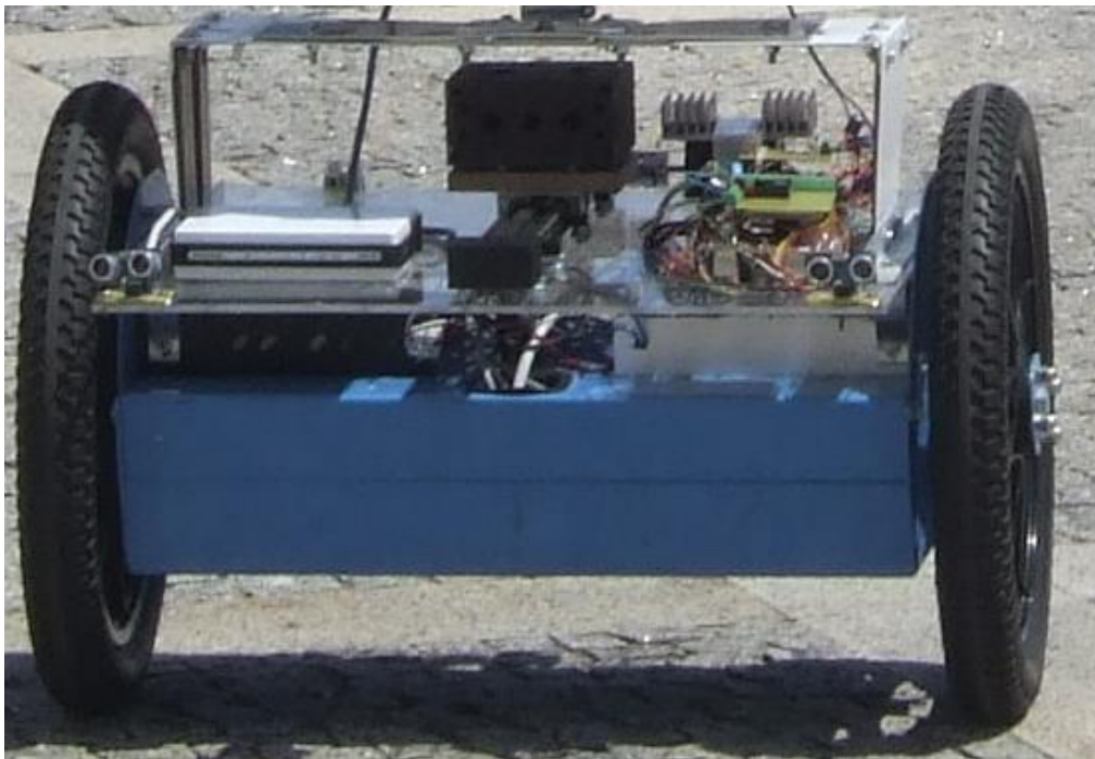
Figura 3-32 - Ultra-sons instalados na parte da frente do robô.
