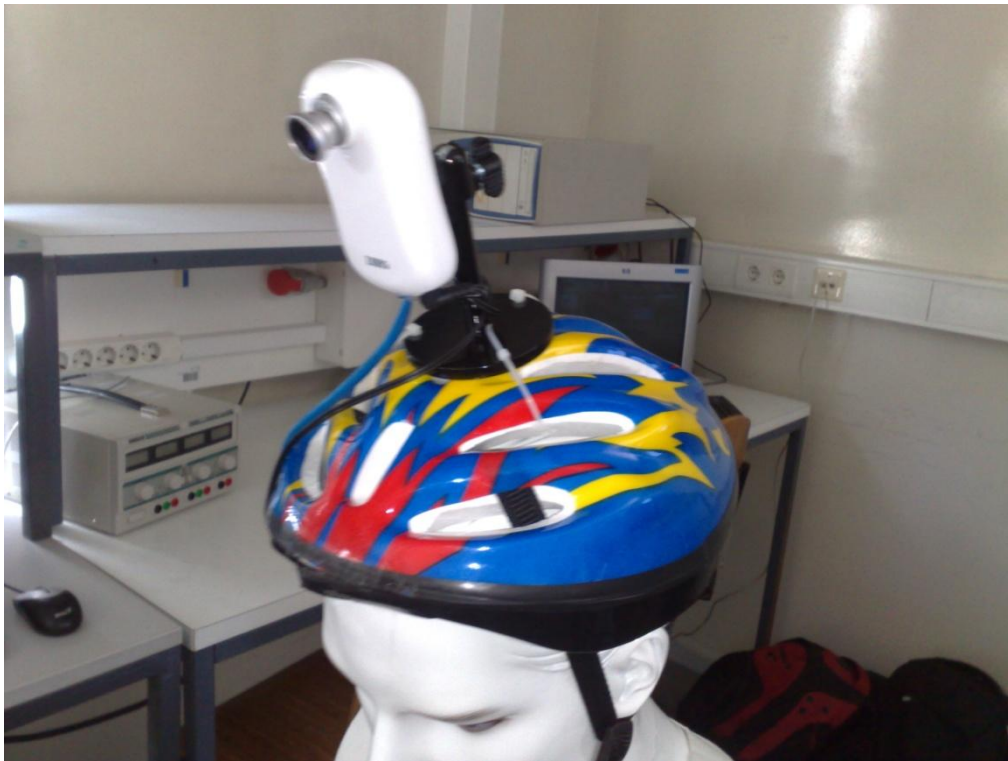
Figura 3-34 - Câmera IP com lente de grande angular instalada ( wide angle lens ).
