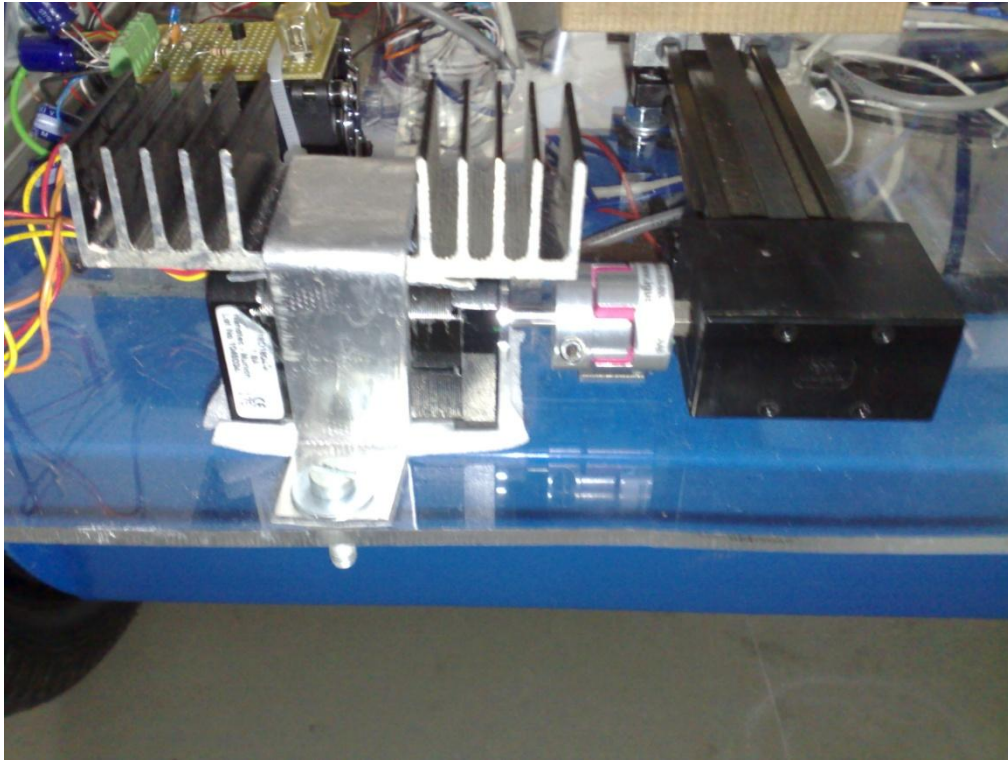
Figura 3-31 - Motor de passo, acoplado à calha linear.
