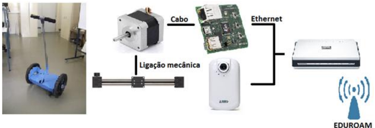
Figura 3-1 - Diagrama de ligação entre o Hardware Adquirido.
