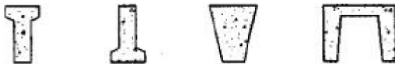
Fig. 12 – Secções Típicas de vigas secundárias de cobertura [8]
