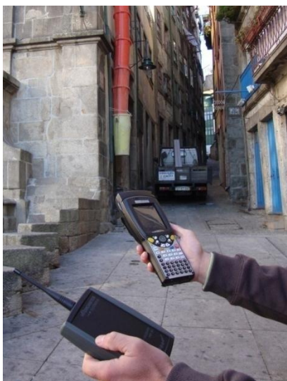
Fig. 2.41 Exemplo de sistema Drive-by , TPL composto por um receptor de rádio e um PDA (Águas do Porto, 2011)
