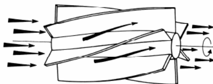
Fig. 2.14 Esquema de funcionamento de turbina helicoidal (Colarejo, 2011)
