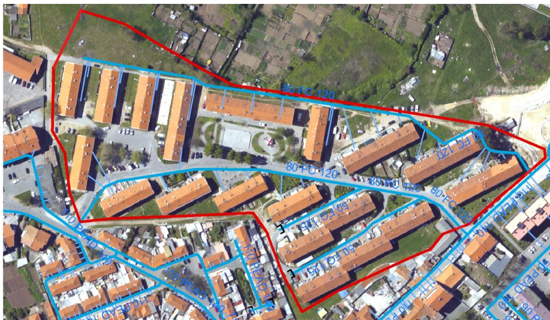
Fig. 4.33 Conduitas e Ramais no Bairro de Aldoar (Águas do Porto EEM)
