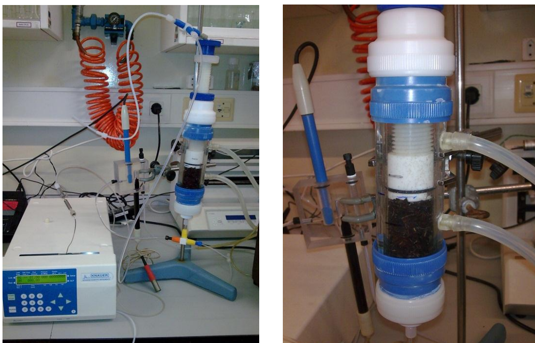
Figura 10 - Instalação experimental para realização dos ensaios em coluna de leito fixo, (esq.); Enchimento da coluna com alga Laminaria digitata, (dir.).
