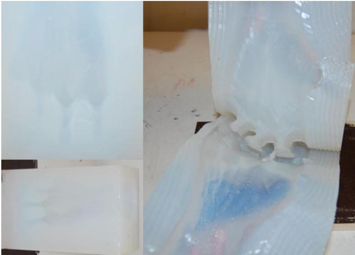
Figura 131: Molde em silicone criado
