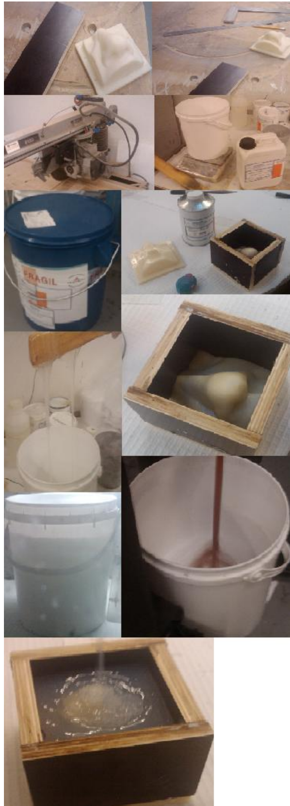
Figura 50: Fases de construção do molde
