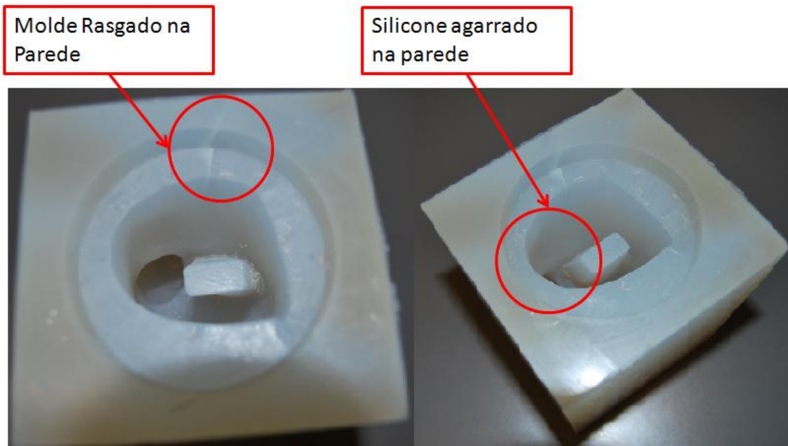
Figura 120: Molde rasgado e silicone agarrado nas paredes
