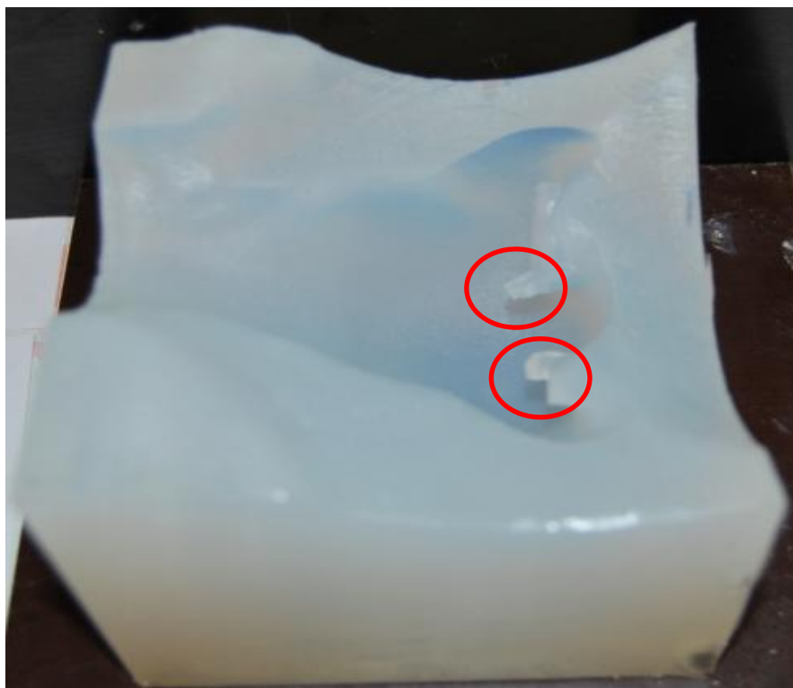
Figura 87: Segundo molde vazado com os cones em silicone
