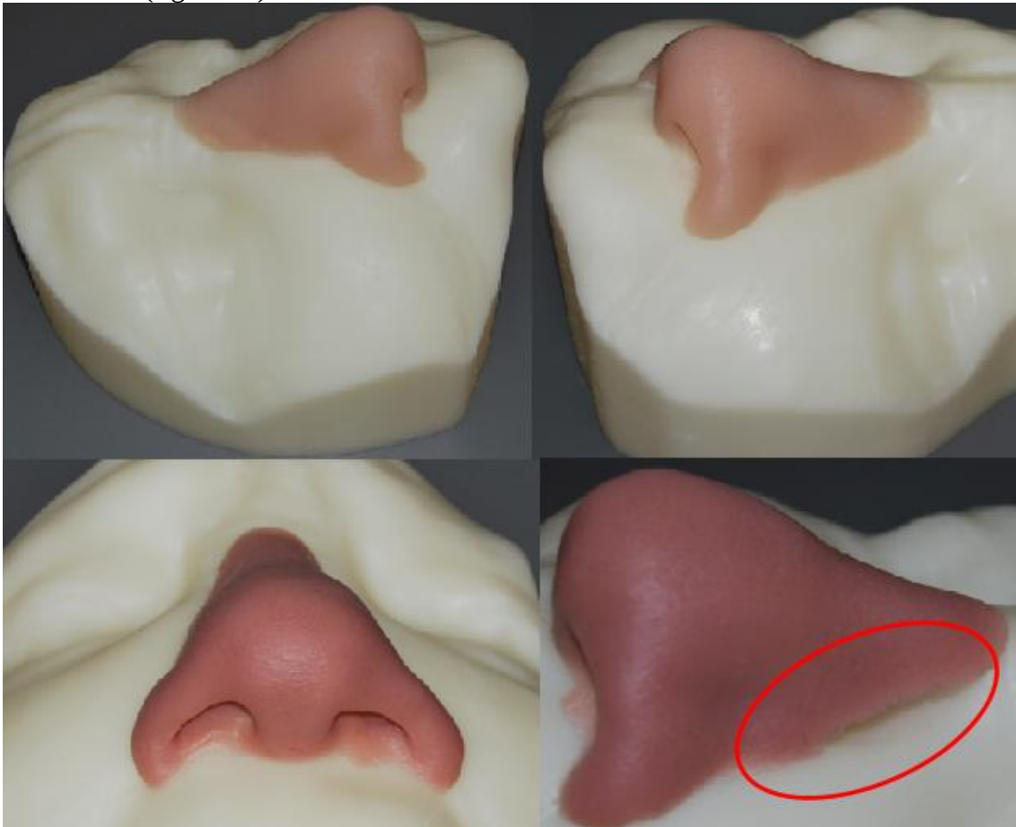
Figura 89: Falha de enchimento na primeira prótese
