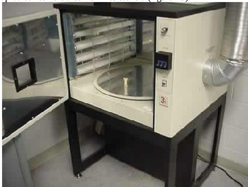
Figura 49: Forno UV utilizado para cura dos protótipos SLA existente no INEGI
