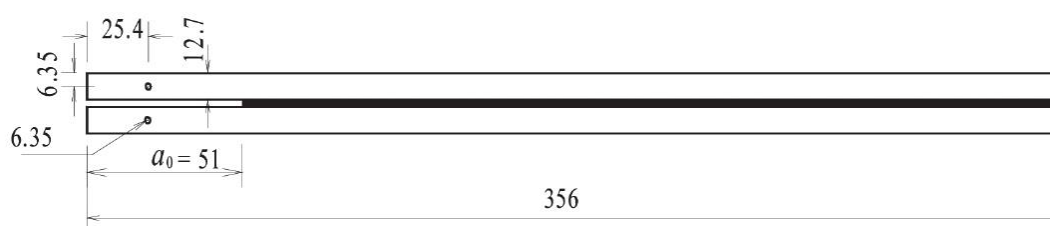
Figura 3 - Geometria do ensaio DCB conforme a norma ASTM D3433-99 [18]
