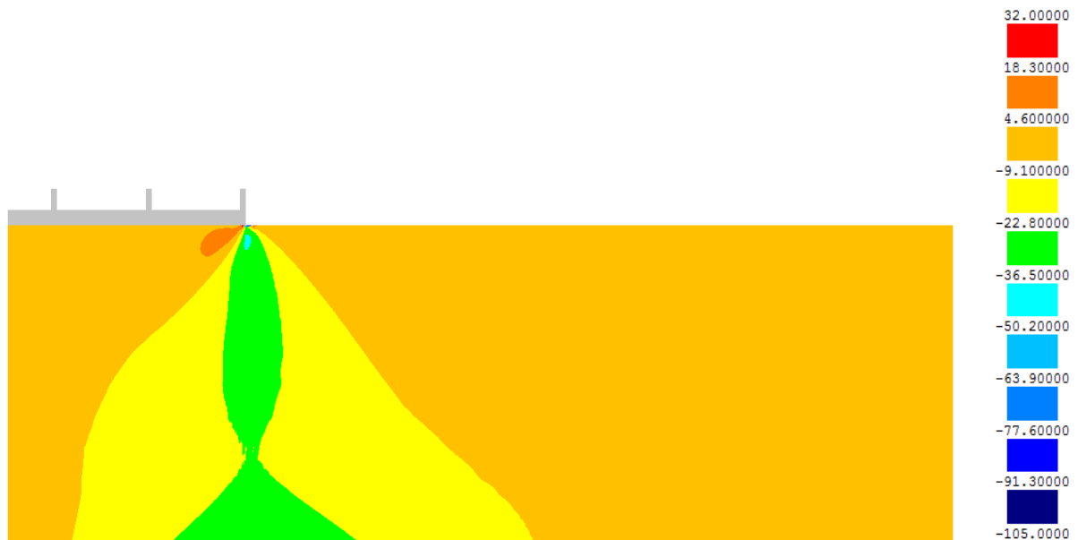
Fig. 6.10 – Tensão de corte no maciço terroso
