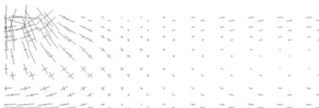
Fig. 4.14 - Cruzetas de tensões principais no ensoleiramento
