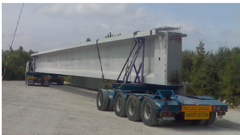
Fig.1.3. – Transporte de uma viga pré-fabricada [3]
