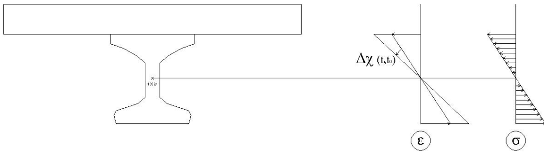
Fig.3.7. – Diagrama de deformação ( \epsilon ) e de tensão ( \sigma ) na secção para a acção do peso próprio. Variação de deformação \Delta\chi(t, t_0)
