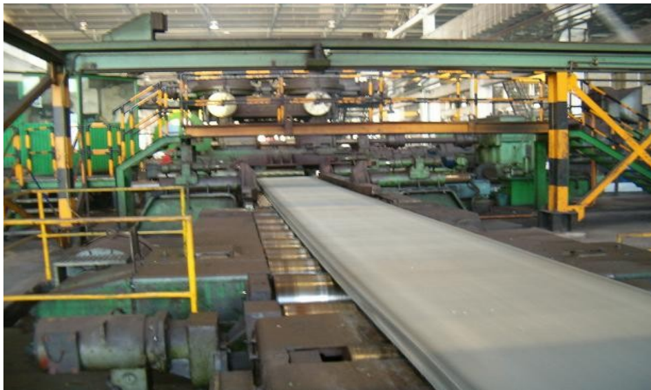
Figura 14 – Fotografia da placa na laminagem a quente (laminador Duo)
