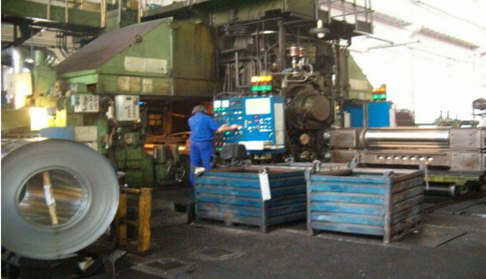
Figura 17 – Bobina a ser laminada a frio no laminador Alcoa
