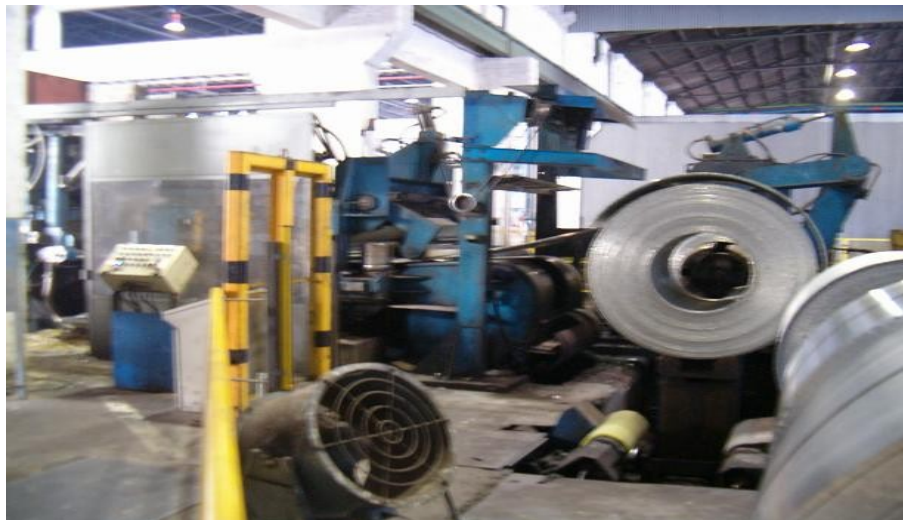
Figura 16 – Fresadora a retirar camadas superficiais à bobina
