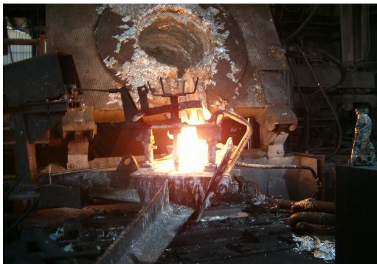
Figura 8 – Vazamento da liga fundida de ZnCuTi
