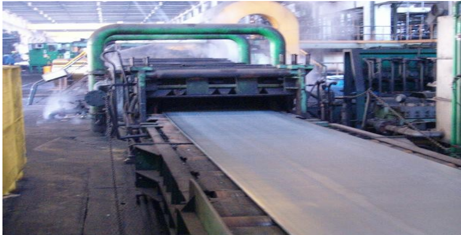
Figura 15 – Fotografia da placa no laminador Duo a entrar no túnel de arrefecimento
