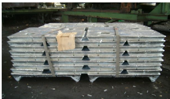
Figura 12 – liga de Zn SHG (Special High Grade) com alto grau de pureza 99,995% Zn.
