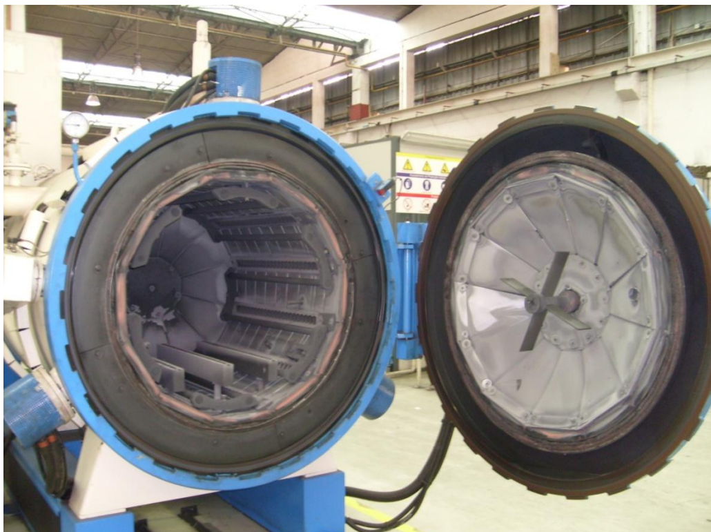
Figura 1.2 - Forno utilizado para efectuar a têmpera
