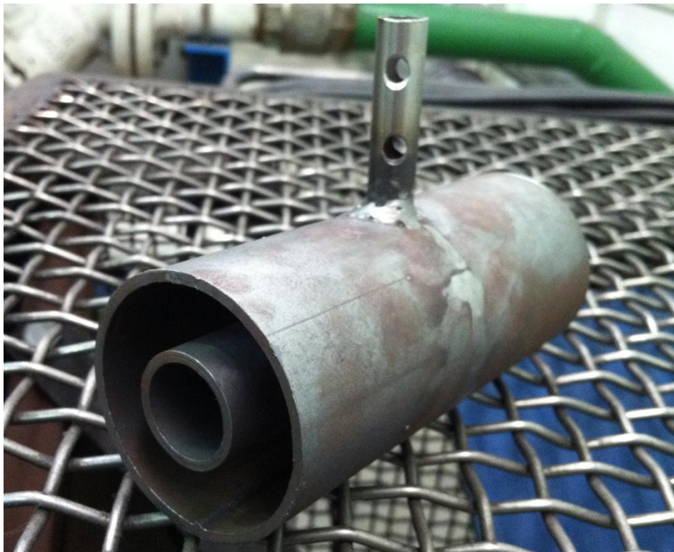
Figura 3.7 - Escudo de radiação realizado pela F. Ramada
