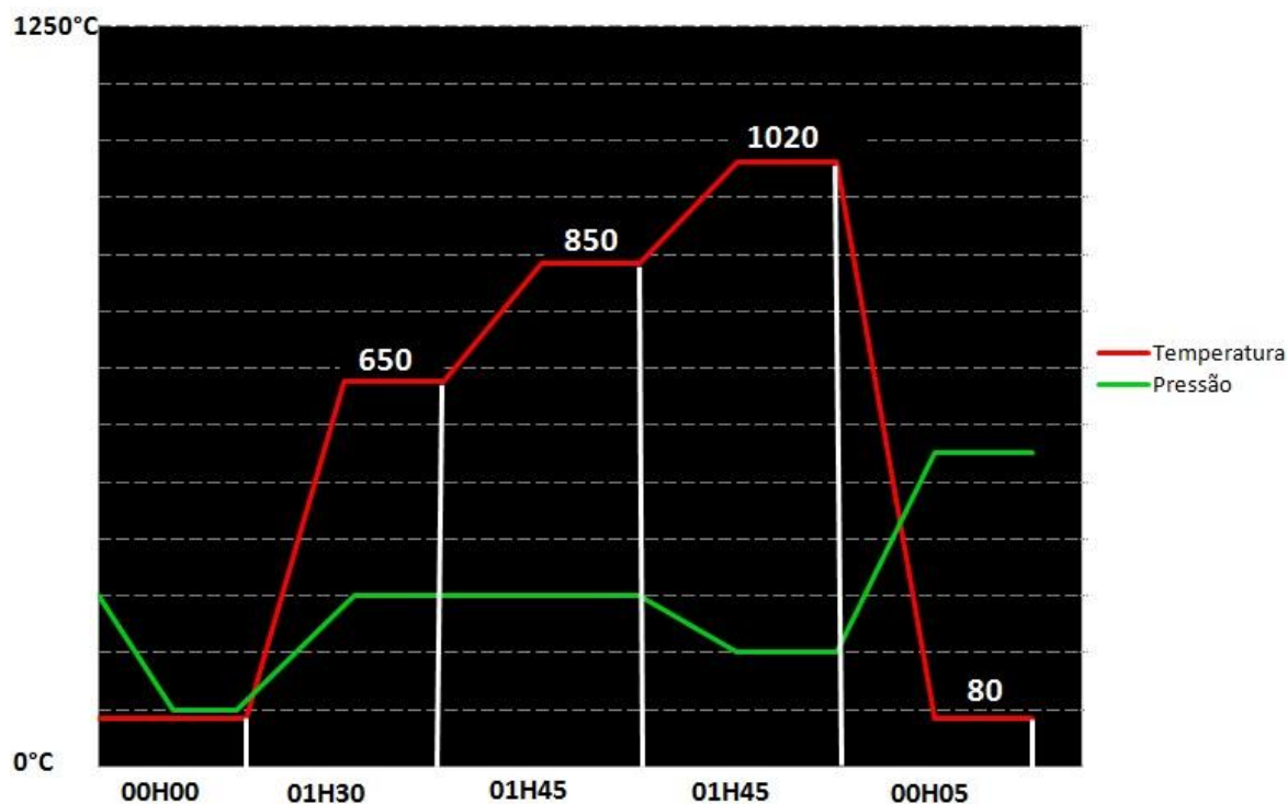
Figura 1.3 - Ciclo de têmpera (temperatura e pressão)
