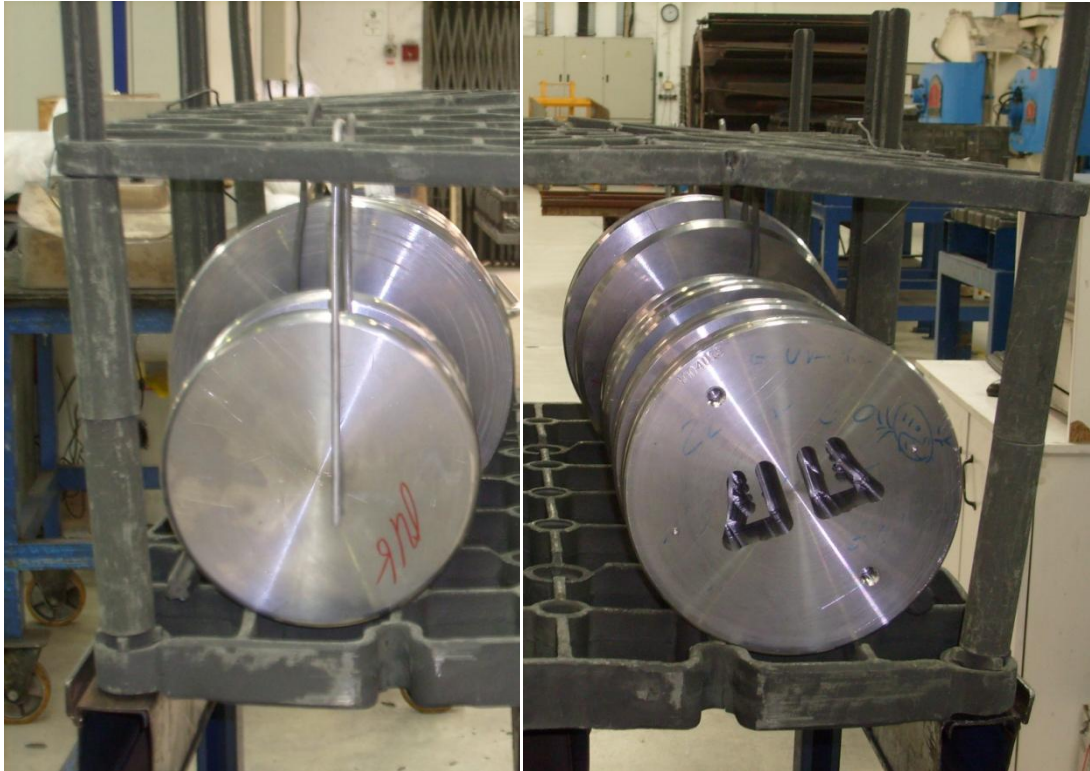
Figura 1.1 - Matrizes de aço que vão ser temperadas
