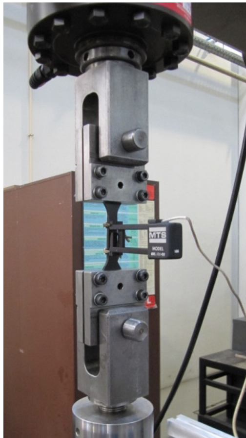
Figura 42 - Pormenor do extensómetro montado no provete maciço
