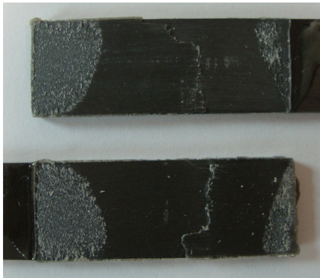
Figura 87 - Superfície rotura juntas de sobreposição simples com AV138 comprimento de sobreposição de 50 mm
