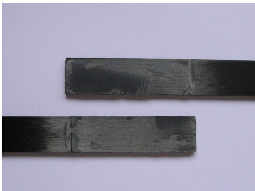
Figura 63 - Roturas obtidas nas juntas com comprimento de sobreposição de 50 mm
