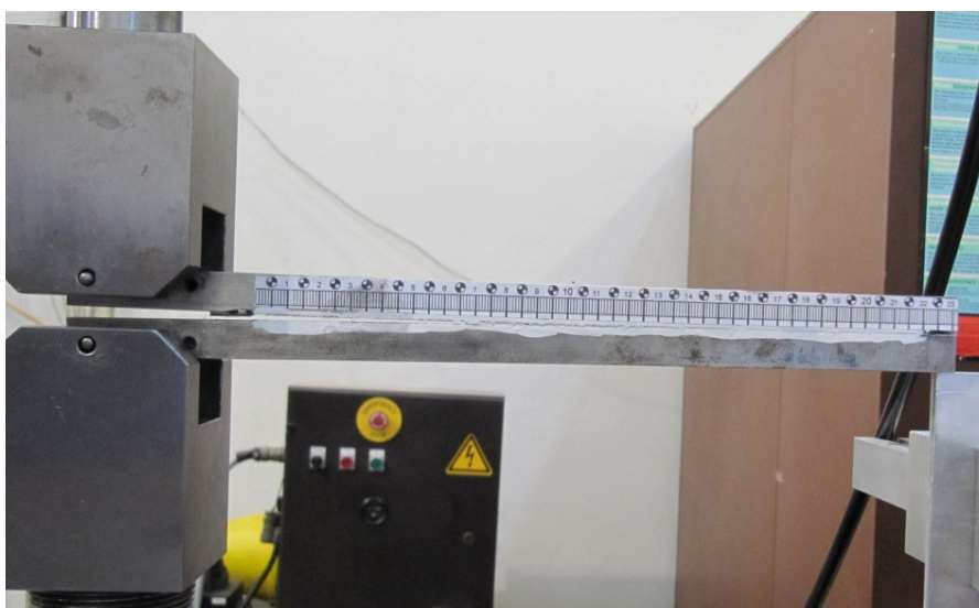
Figura 45 – Registo do crescimento da fenda durante ensaio DCB
