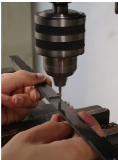
Figura 41 - Remoção dos excessos de adesivo
