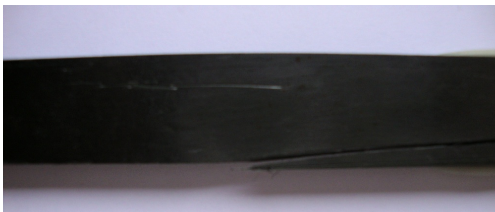
Figura 64 - Rotura no compósito observado em algumas juntas de sobreposição simples com 80 mm de sobreposição
