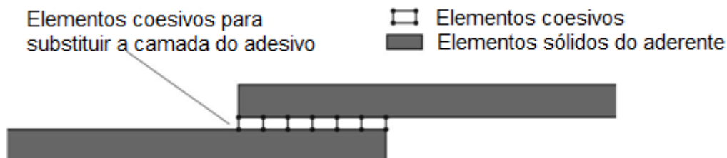
Figura 15 – Utilização de elementos coesivos para modelação da camada de adesivo numa junta de sobreposição simples
