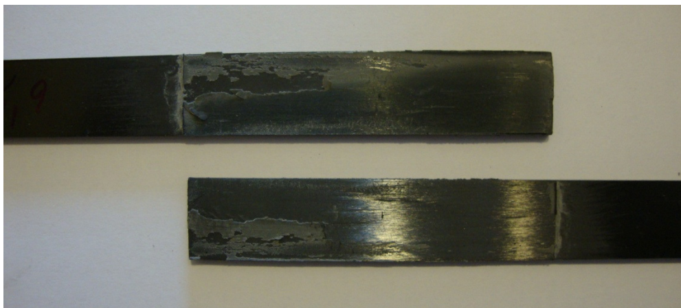
Figura 91 – Superfície de ruptura da junta com comprimento de sobreposição de 70 mm com o adesivo 7888
