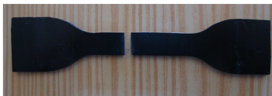
Figura 53- Provete maciço de adesivo 7888 após ensaio bulk
