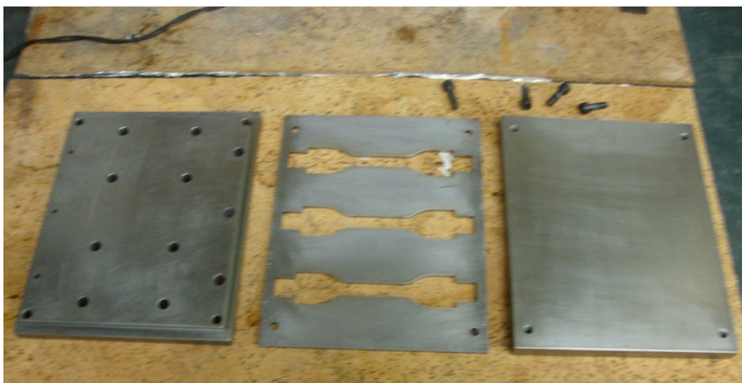
Figura 20 - Molde utilizado para fabrico de provetes maciços
