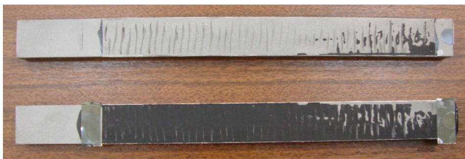
Figura 56 - Rotura observada nos provetes dos ensaios DCB com adesivo SikaForce® 7888
