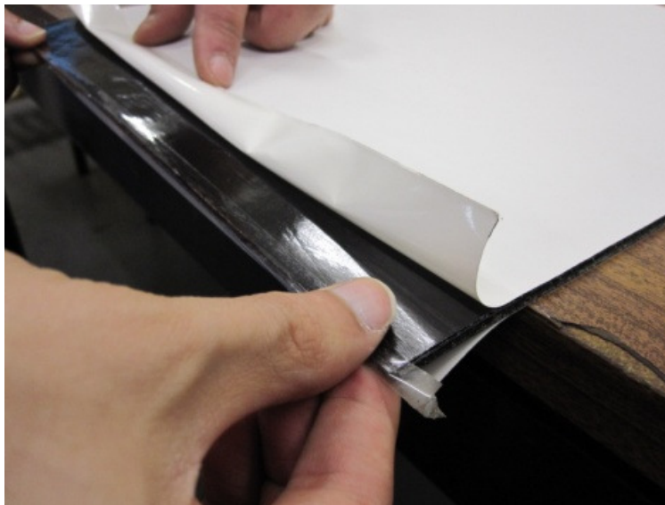
Figura 33 - Pormenor da colocação de fita-cola ao longo da placa
