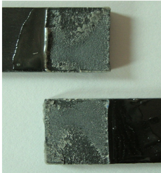
Figura 60 – Rotura coesiva nas juntas com 10 mm sobreposição com adesivo AV138
