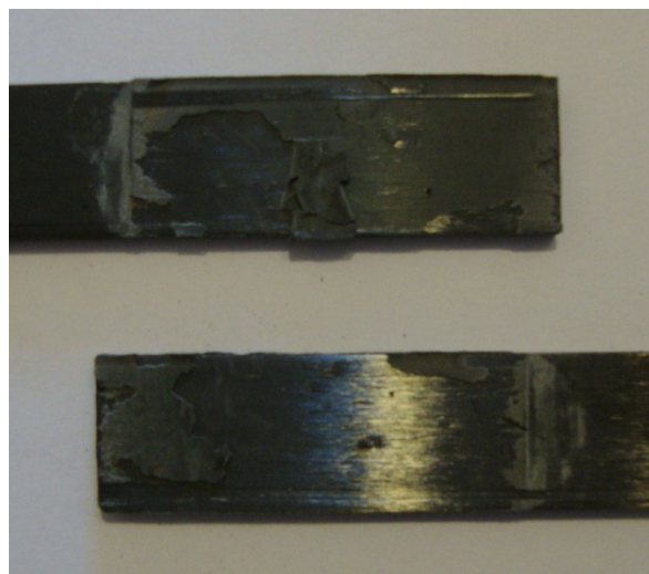
Figura 89 – Superfície rotura da junta com comprimento de sobreposição de 40 mm com o adesivo 7888
