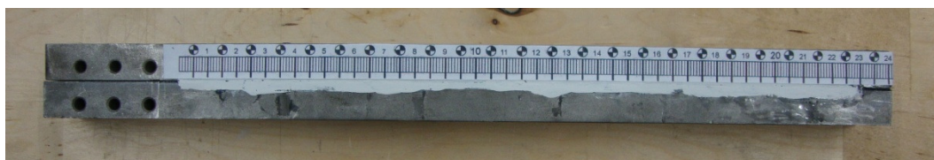
Figura 30 - Provede ENF com escala colada e pintado com líquido corretor
