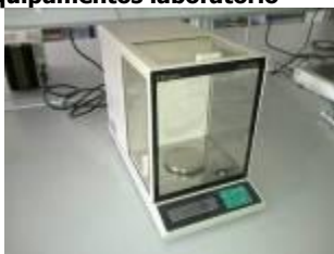
Balança analítica –Chyo JL 180 Max: 180g Sensibilidade: 0,1mg
