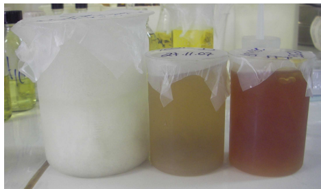
Figura 6 - Aspecto das soluções retiradas do reactor após a realização dos ensaios de oxidação, para uma concentração de \text{H}_2\text{O}_2 de 120, 71 e 46 \text{g.L}^{-1} (da esquerda para a direita, apenas a de 46 \text{g.L}^{-1} foi filtrada).
