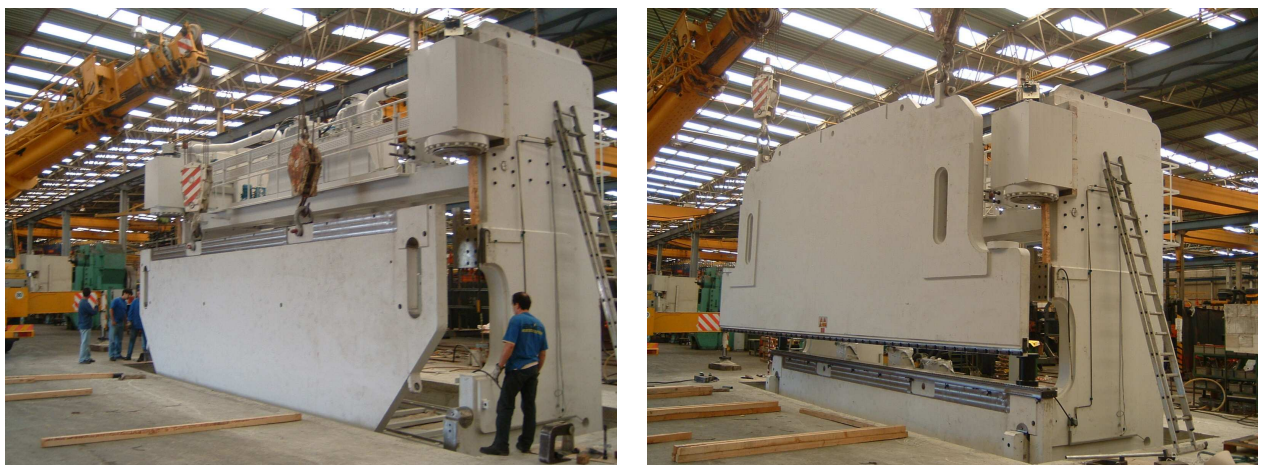
Figura 2.13 - Montagem de uma quinadora da ADIRA QIH125090
