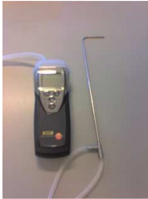
Figura 27: Manómetro digital e tubo de pitot.
