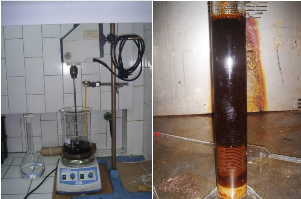
Figura 5 – Detalhes da instalação experimental: cozimento do sabão (A) e proveta de decantação do tall-oil, no interior duma estufa (B).
