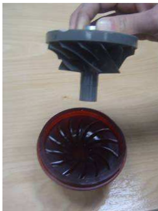
Figura 3-60 – Exemplo de um Master de silicone retirado da respectiva cavidade de poliuretano.
