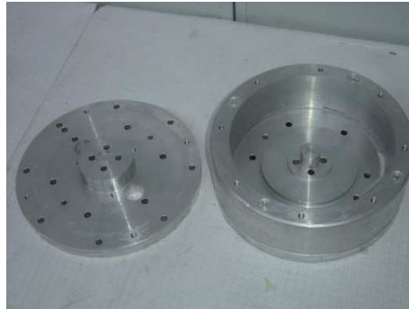
Figura 3-19 – Ferramenta em alumínio para a fabricação da base em resina.
