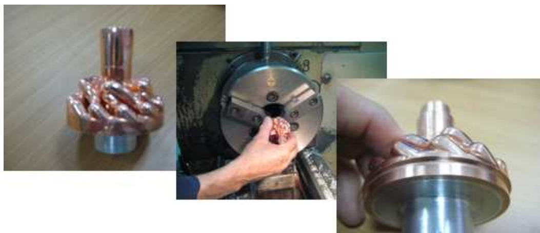
Figura 3-76 – Exemplo da alteração geométrica realizada ao cobre depositado.
