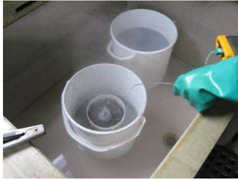
Figura 3-77 – Ilustração da reacção de dissolução do alumínio.
