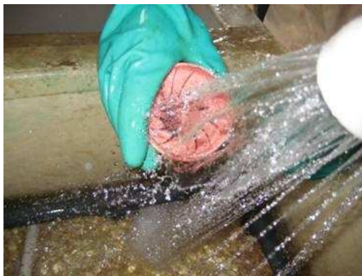
Figura 3-79 – Limpeza da cavidade de cobre com água corrente.
