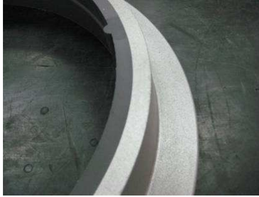
Figura 3-46 – Pormenor real de uma caixa de moldação.
