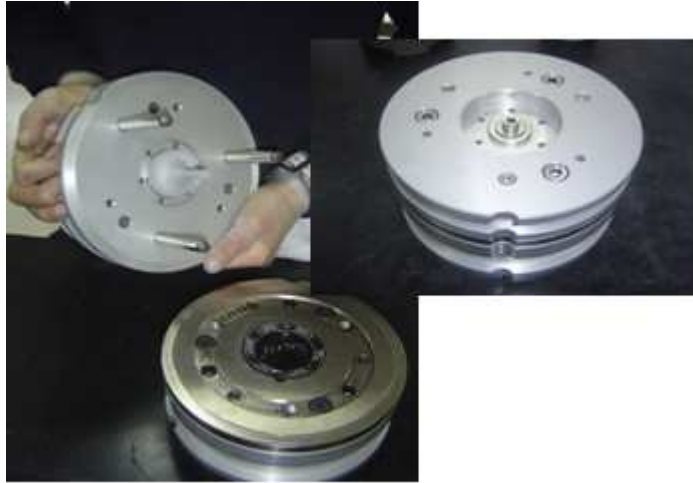
Figura 3-53 – Exemplo do fecho da ferramenta após vazamento do silicone.
