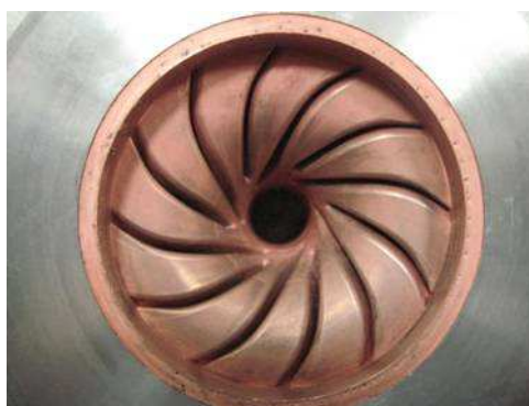
Figura 3-82 – Aspecto final da cavidade de cobre, após o procedimento de limpeza e abrillhantamento.
