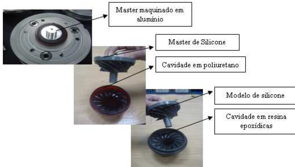
Figura 3-56 – Esquema da sequência dos passos do processo poliuretano.
