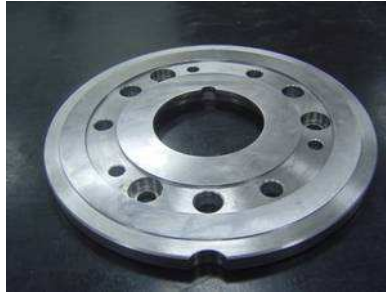
Figura 3-26 – Anel central da ferramenta de reprodução de modelos de silicone (moldes).
