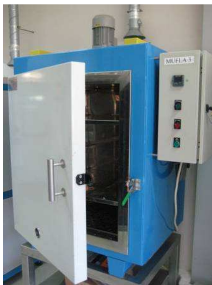
Figura 3-9 – Mufla para efectuar curas a temperatura controlada.
