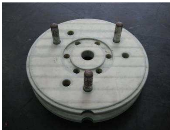
Figura 2-12 – Exemplo de um componente protótipo em LOM de uma ferramenta.
