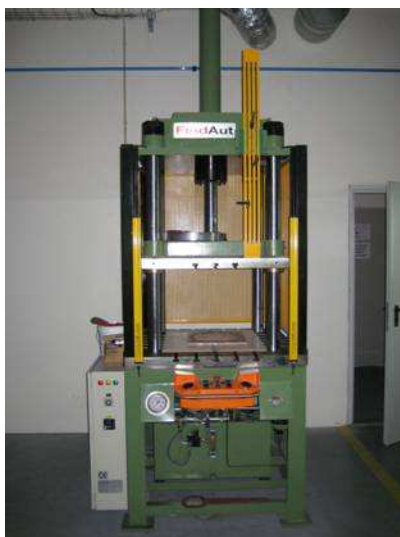
Figura 3-10 – Prensa hidráulica usada na desmoldagem das caixas de moldação.
