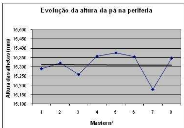
Figura 3-67 – Evolução dimensional dos Masters realizados a partir da mesma cavidade de silicone.
