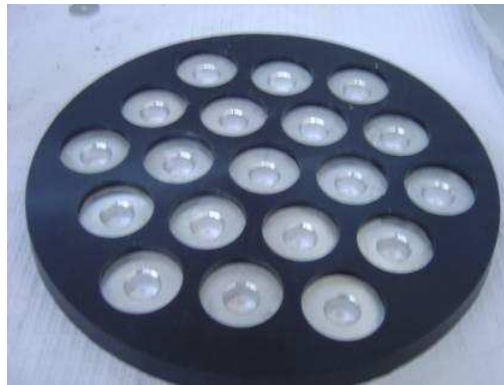
Figura 3-33 – 1ª e 2ª geração de placa molde.
