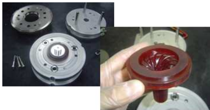
Figura 3-57 – Imagens demonstrativas da execução da cavidade de poliuretano.
