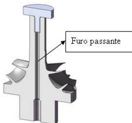
Figura 3-74 – Imagem ilustrativa da alteração do Master para se proceder à electrodeposição de cobre.
