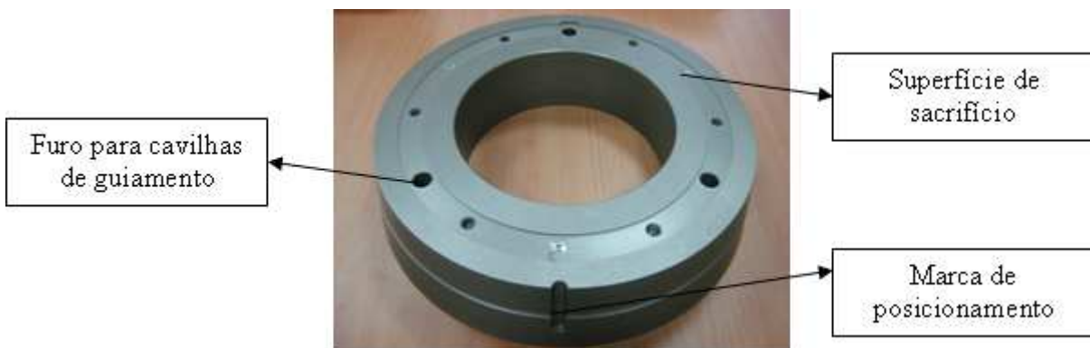
Figura 3-47 – Peça interior da ferramenta de revestimento da caixa de moldação.
