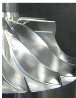
Figura 3-58 – Exemplo da geometria complexa de um Master maquinado em alumínio.
