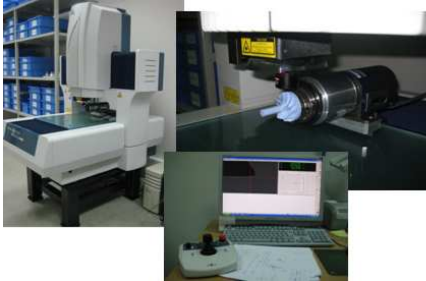
Figura 3-11 – Imagens da máquina de controlo dimensional "Quickvision" da "Mitutoyo".
