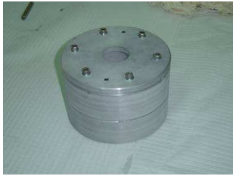
Figura 3-22 – Conjunto da ferramenta de reprodução em resina.
