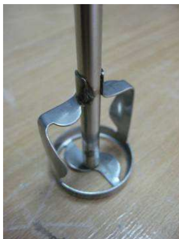
Figura 3-8 – Hélice usada nas misturas automáticas de resina epoxídica e silicone.
