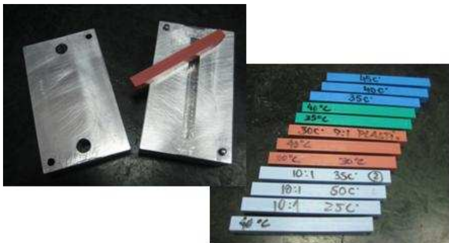
Figura 3-94 – Imagens ilustrativas do molde e respectivos provetes.
