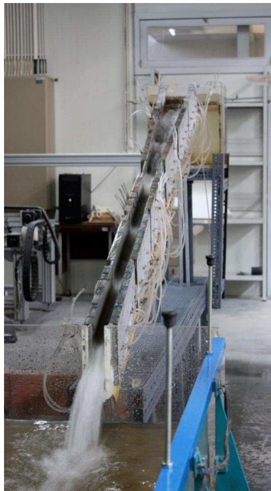
Figura 3.3. Reservatório de tranquilização e canal descarregador de cheias em degraus.
