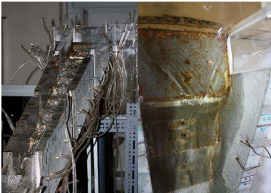
Figura 3.7. Tubos piezométricos e tomadas de pressão instalados no descarregador em análise.
