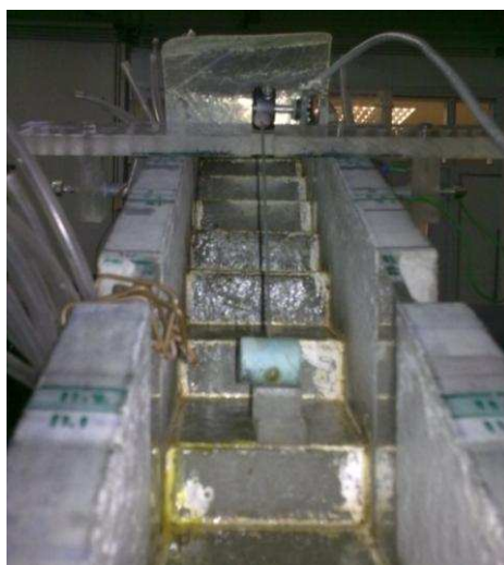
Figura 3.12. Calibração do dispositivo flutuador/potenciómetro, com a aplicação de placas em perspex de diferentes alturas.
