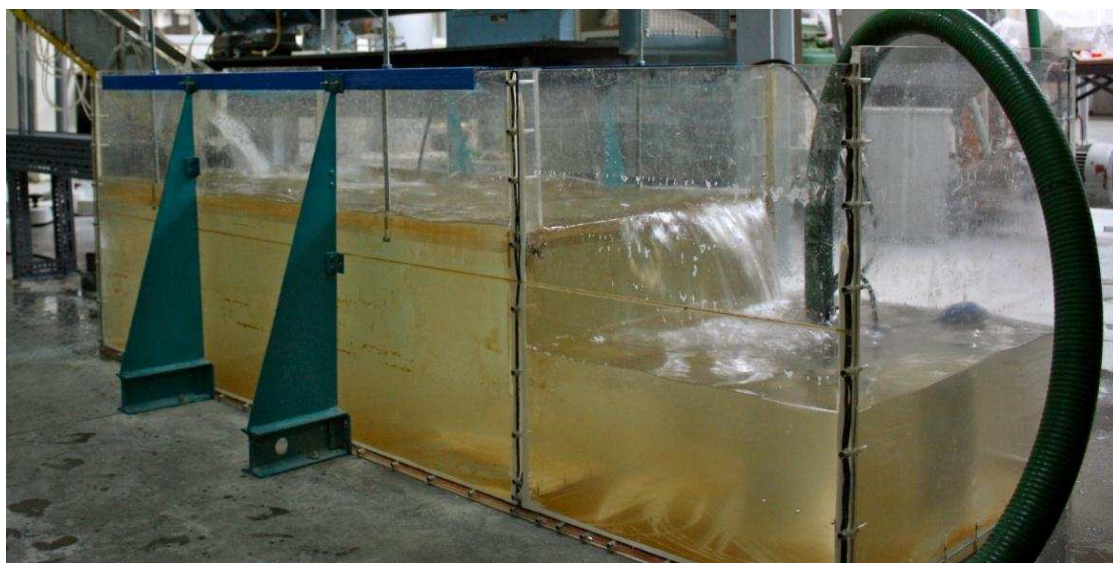
Figura 3.4. Canal de restituição e reservatório de bombagem.
