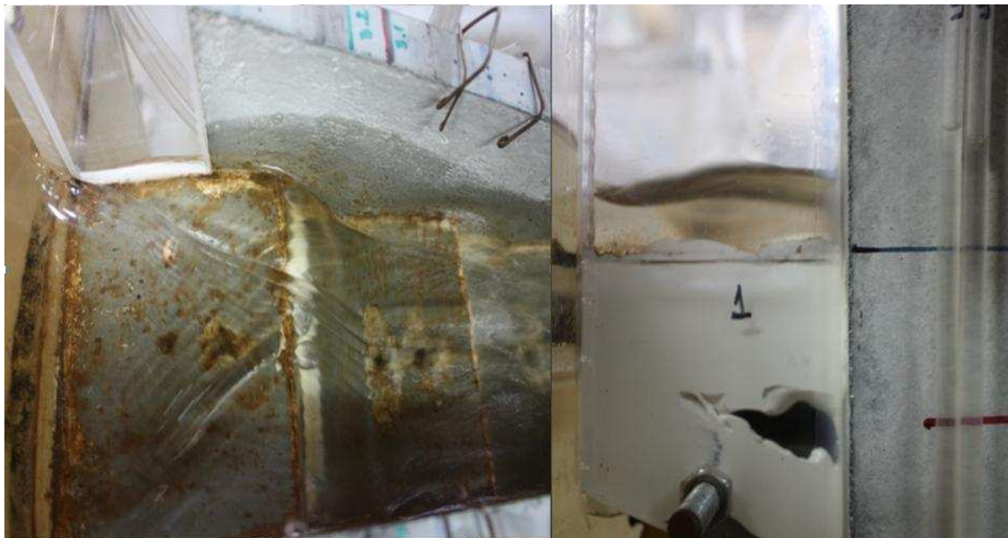
Figura 4.10. Tomadas de pressão existente no degrau 1 (pormenor superior e tubos piezométricos laterais).
