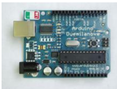
Figura 2.2 – Placa Arduino Duemilanove
