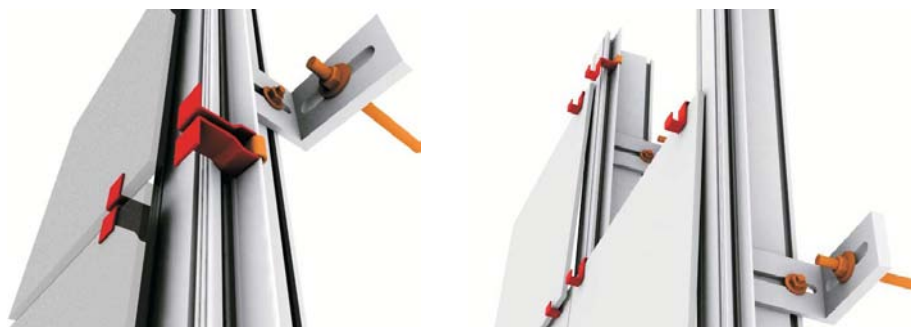
Figura 2.47 – Ancoragem por grampos com e sem sobreposição [18]
