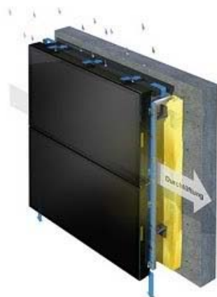
Figura 2.43 – Esquema de fachada com painéis fotovoltaicos (esq.) e sua aplicação num edifício (dir.) [42]
