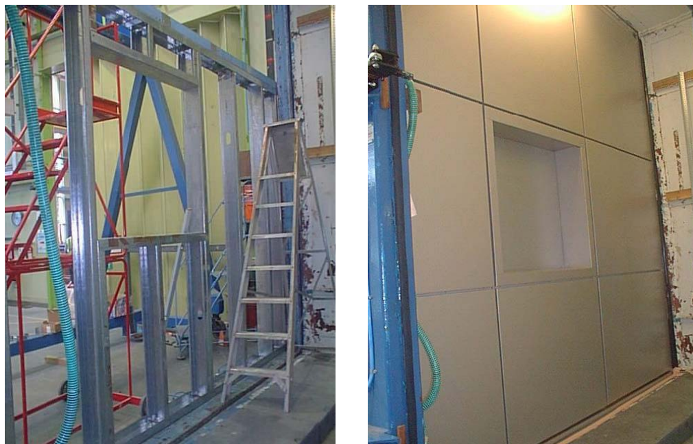
Figura 4.4 – Protótipo de fachada para ensaio com estrutura (esq.) e revestimento (dir.) [66]
