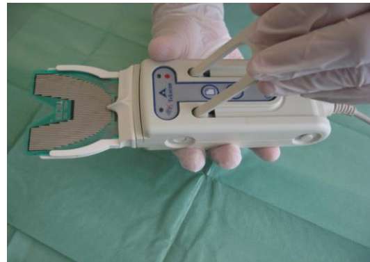
Fig. 14 d) – Fixação do sistema de travamento com o sensor.
