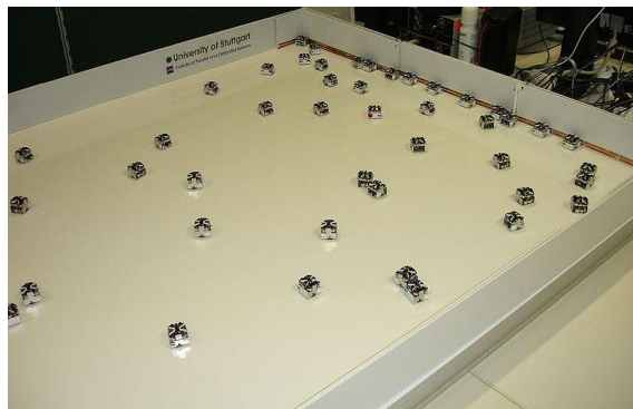
Figura 3.3: Exemplo de uma arquitectura Swarm : Jasmine micro-robots [2].
