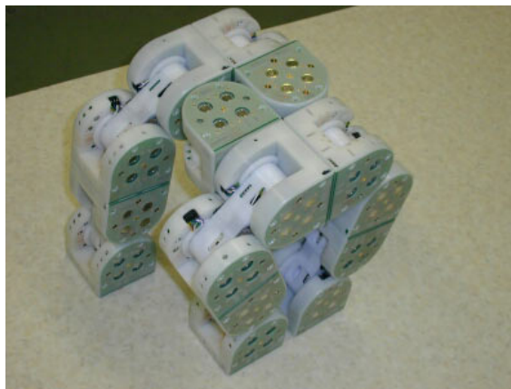
Figura 3.2: Exemplo de uma arquitectura CEBOT: MTRAN 3 [1].
