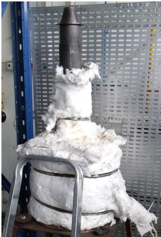
Figura 5.8 Leito fluidizado envolto num isolamento de fibra cerâmica.
