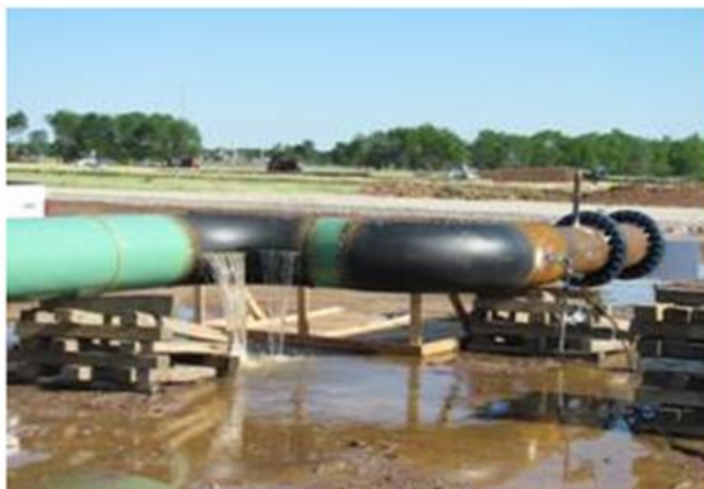
Figura 12 – Exemplo de uma fuga de uma linha, neste caso durante um ensaio
