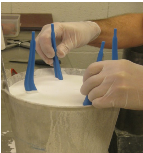
Figura 100 - 1ª imersão na barbotina seleccionada
