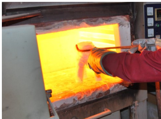
Figura 120 - Colocação da carapaça no forno de pré-aquecimento
