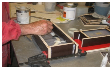
Figura 74 - Aplicação de desmoldante
