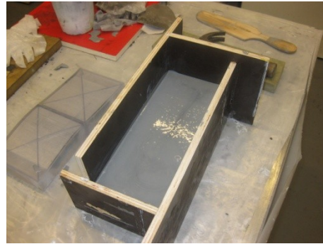
Figura 79 - Vazamento da segunda parte de resina
