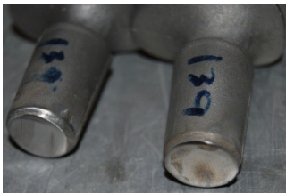
Figura 138 - Corte fino das próteses da barbotina 139
