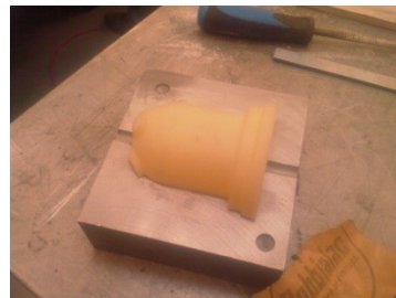
Figura 85 - Meio molde preparado para a 2ª metade
