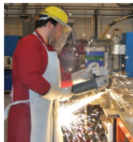
Figura 134 - Corte com rebarbadora
