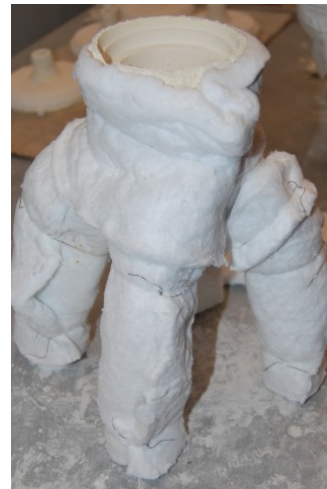
Figura 119 - Aspecto da carapaça com fibra cerâmica
