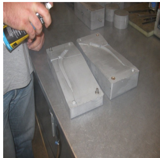
Figura 90 - Aplicação do desmoldante no molde
