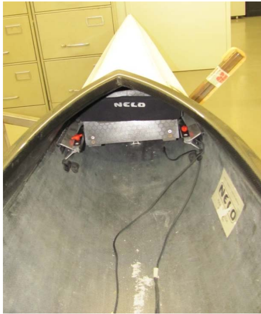
Figura 17: Finca-pés colocado no interior do kayak
