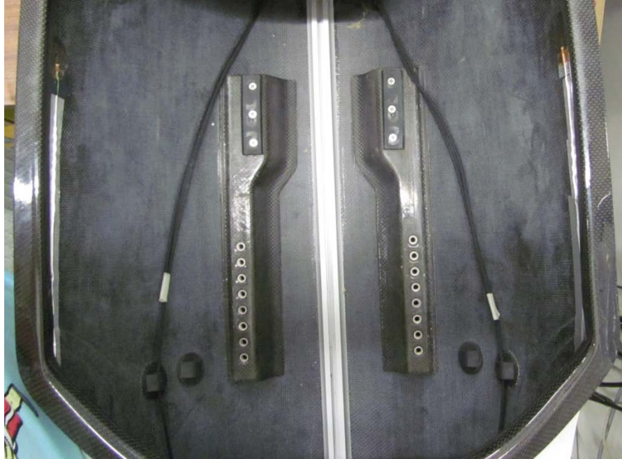
Figura 28: Aspecto final da montagem dos dois extensómetros no kayak
