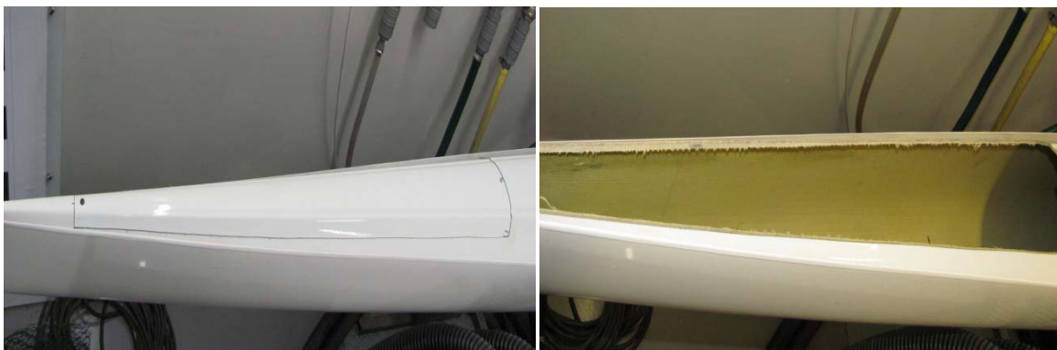
Figura 18: Secção de corte no kayak
