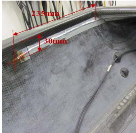
Figura 26: Localização de um dos extensómetros
