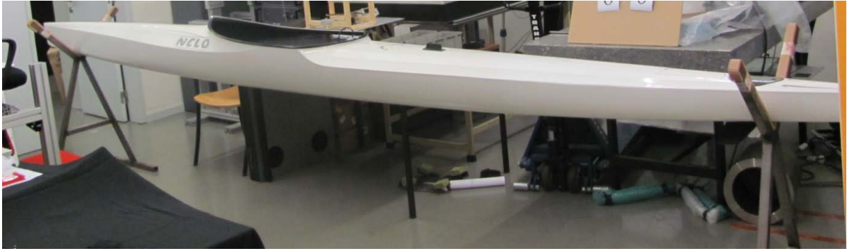
Figura 32: Posicionamento dos apoios nas pontas do kayak
