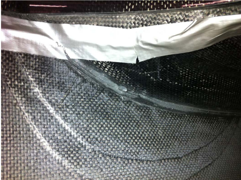
Figura 50: Reforço na parte interior do kayak, na zona do vinco no cockpit
