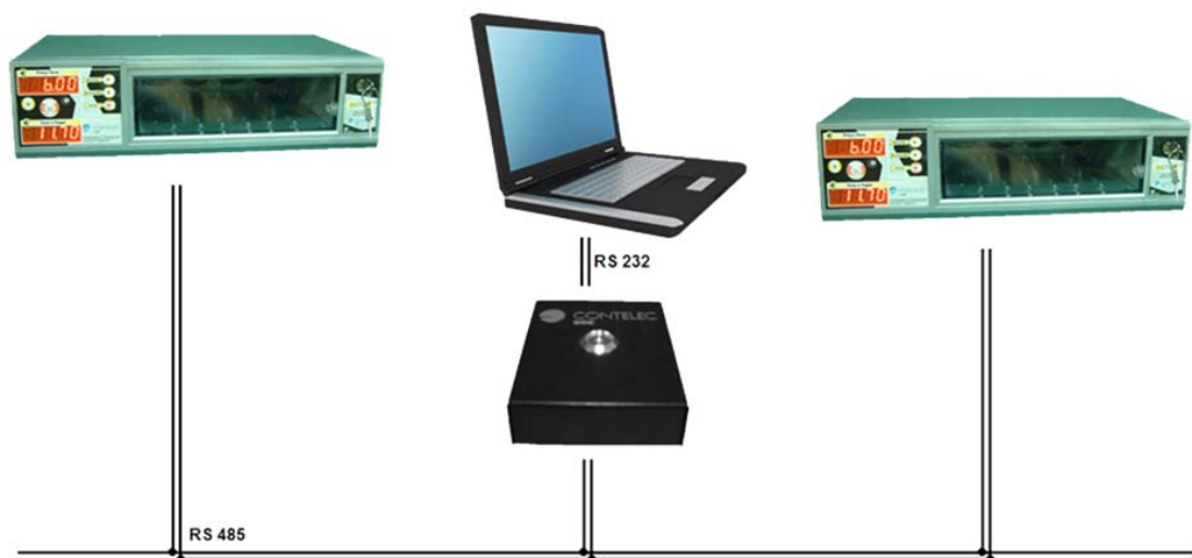
Figura 1.1 - Interligações do sistema existente
