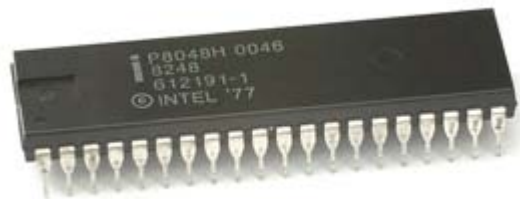
Figura 2.4 - Intel 8048: o primeiro microcontrolador
