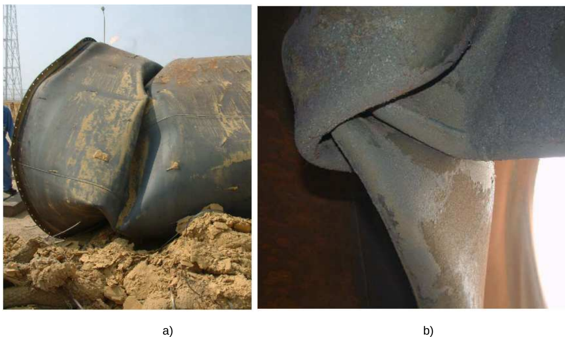
Figura 2.6 – Fotografias do revestimento derretido: a) após parcial desmatagem; b) fotografia a partir do interior
