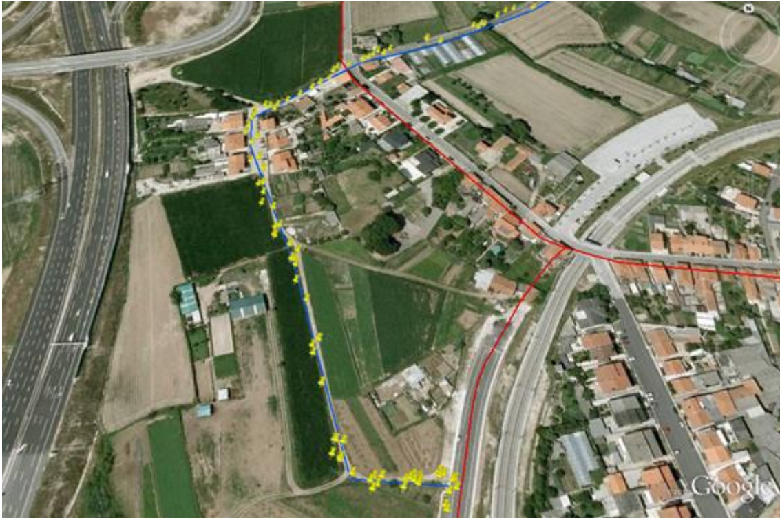
Figura 4.7: Detecção de novas vias a partir de vários tracks GPS
