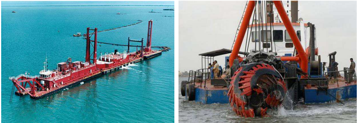
Fig. 2.42 – Grande draga de sucção e repulsão e exemplo de “cutter” [56].
