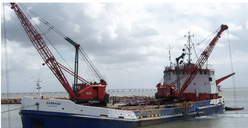
Fig. 2.39 – Draga de baldes com porão de transporte [53].
