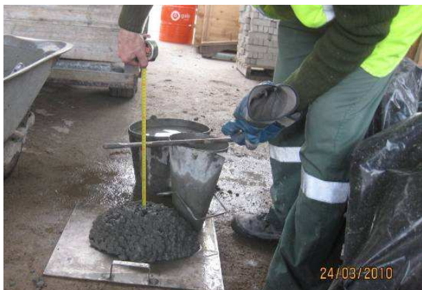
Fig. 4.6 – “Slump Test” em obra.
