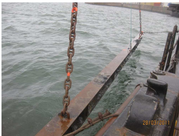
Fig. 3.32 – Rocega no batelão “Sá Nogueira”.
