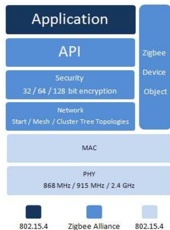
Figura 3.1 - Pilha Protocolar IEEE 802.15.4/ ZigBee .
