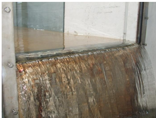
Figura 47 - Comporta de regulação de níveis.
