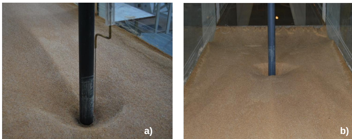
Figura i – Cavidade de erosão final a) vista de montante do pilar; b) vista de jusante
