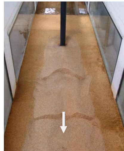
Figura 64 – Efeito da formação da cavidade de erosão vista de jusante (ensaio B1).
