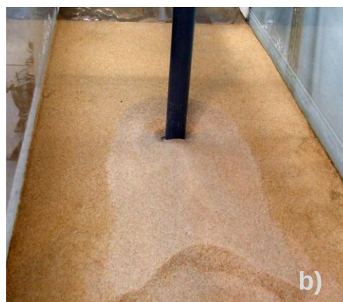
Figura xx - Cavidade de erosão final (ensaio B1). a) Vista de montante; b) Vista de jusante.
