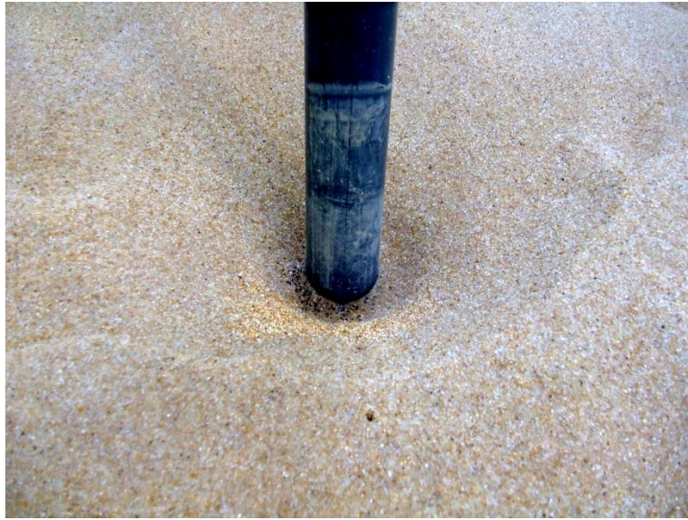
Figura ix - Pormenor da cavidade de erosão final vista de montante (ensaio A2).
