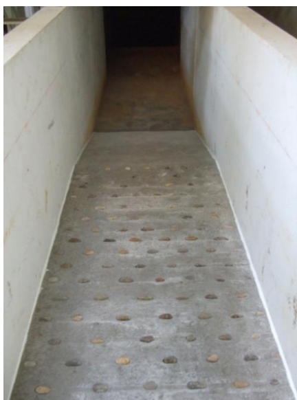
Figura 42 – Zona de entrada do canal, com macro-rugosidades para estabilização do escoamento.
