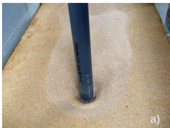
Figura xx - Cavidade de erosão final (ensaio B1). a) Vista de montante; b) Vista de jusante.
