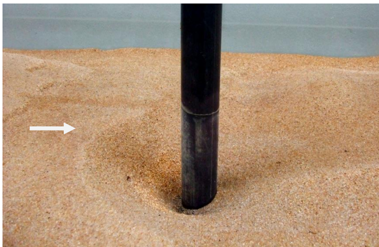
Figura vi - Pormenor da cavidade de erosão final junto ao pilar (vista lateral).
