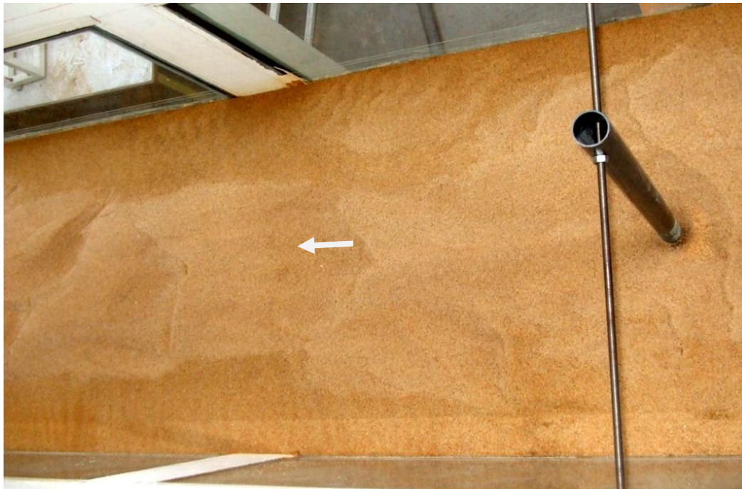
Figura x - Vista superior da cavidade de erosão final (ensaio A2).
