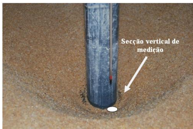
Figura 59 - Localização da secção vertical de medição da profundidade das cavidades de erosão.
