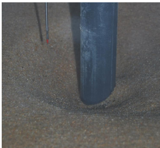
Figura ii - Pormenor da cavidade de erosão final (vista lateral).
