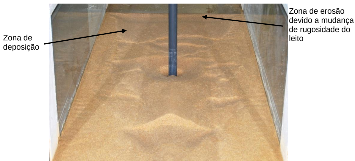
Figura 70 - Zona de erosão e de deposição de sedimentos devido à mudança brusca da rugosidade.
