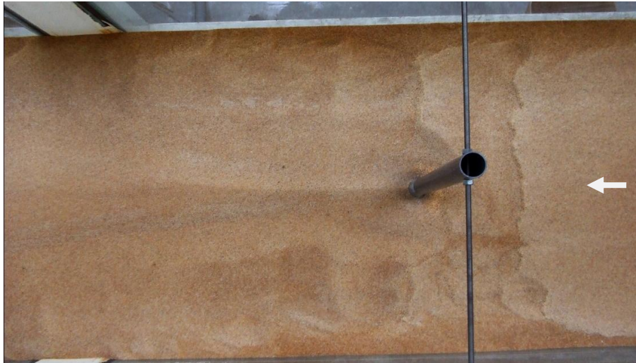
Figura iv - Vista superior da cavidade de erosão final (ensaio Y).
