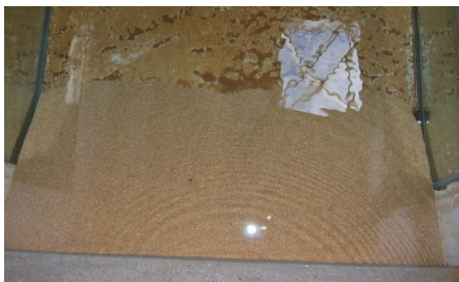
Figura 68 – Pormenor da caixa de retenção de sedimentos no final do ensaio X.
