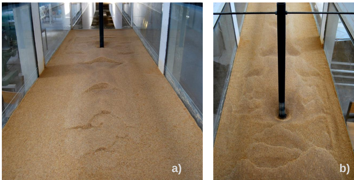
Figura xiii – Cavity final de erosão a) vista de jusante do pilar; b) vista de montante (ensaio A3)
