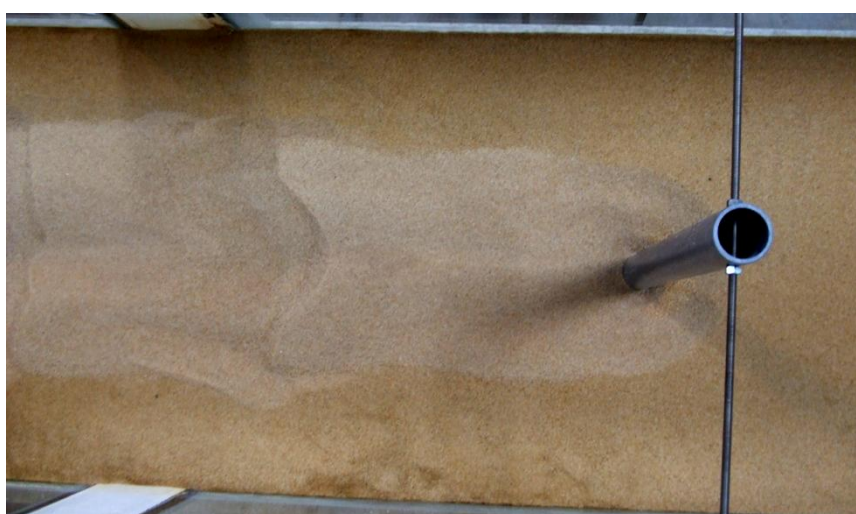
Figura xxi - Cavidade de erosão vista superior (Ensaio B2).
