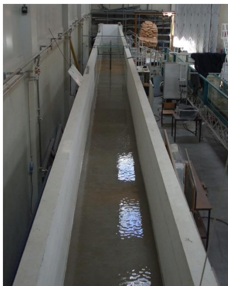
Figura 65 – Canal de ensaios: estabilidade do escoamento ao longo do canal.
