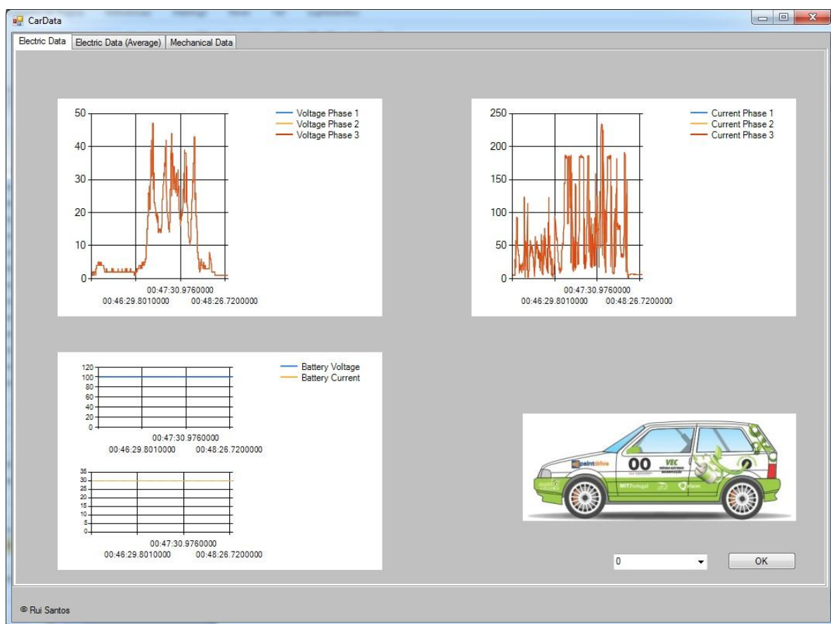
Figura 74 - Valores das tensões e correntes nos barramentos
