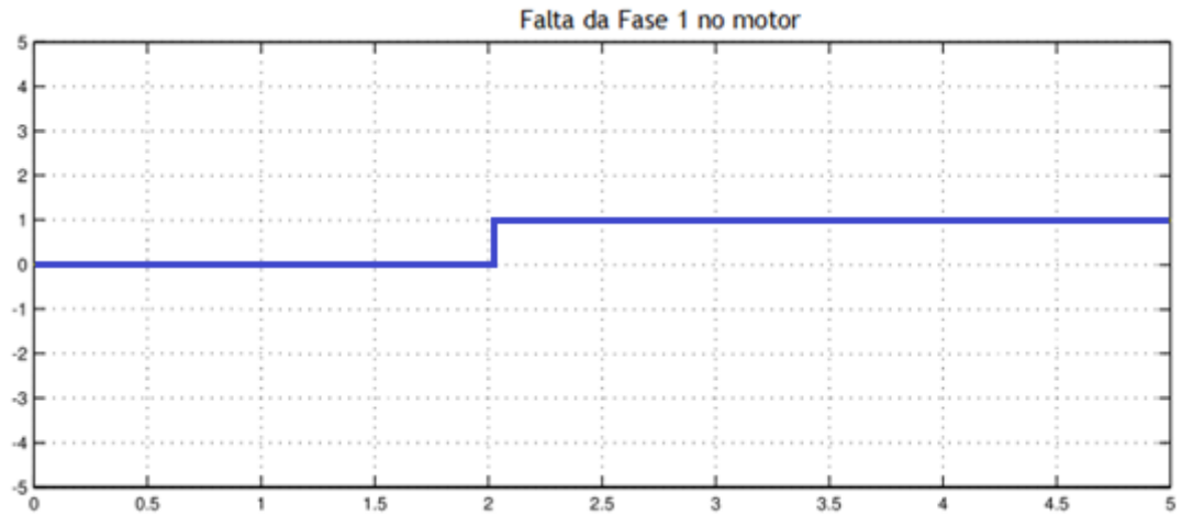
Figura 36 - Gráfico que ilustra a Falta da Fase 1
