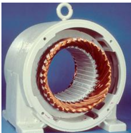
Figura 20 - Aspecto de motor trifásico sem falhas [50]
