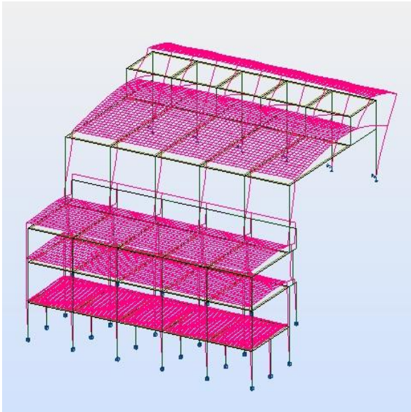
Fig.5.11 – Modo 3 (freq. 3.04 Hz)
