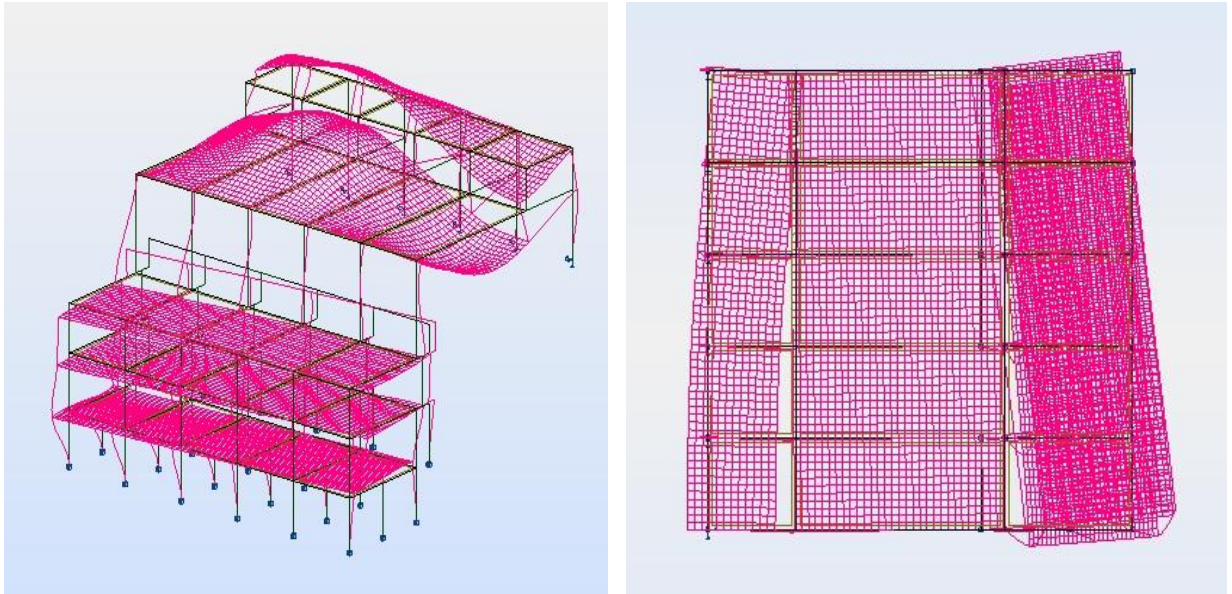
Fig.5.17 – Modo 9 (freq. 5.28 Hz)
