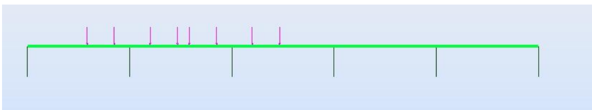
Fig.5.8 – Carga móvel (carga em posição intermédia)
