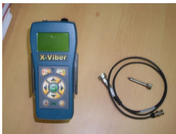
Figura 14 - Equipamento de medição de Vibração com capacidade de Filtragem
