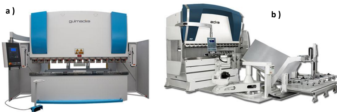
Figura 5 - a) Quinadora (PM Guimadira) e b) célula de quinagem [16].
