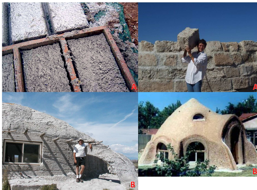
Fig. 42: A – Blocos de papercrete; B – Casas construídas com papercrete. [20]
