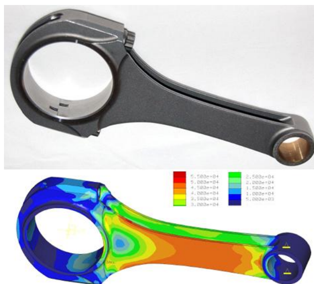
Figura 3.2 – Estudo das tensões na biela de um motor (CIMM, 2011).
