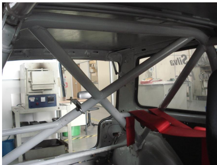
Figura 4.17 – Arco de segurança. Ausência de elementos diagonais no arco principal.
