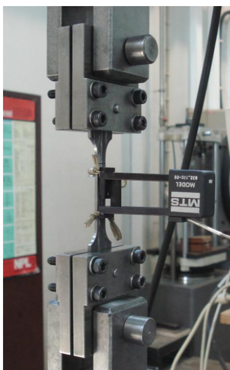
Figura 4.13 – Provete instalado na máquina e extensómetro.
