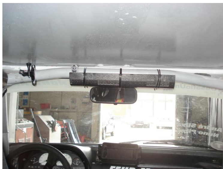
Figura 4.18 – Arco de segurança. Ausência de reforços de tejadilho.
