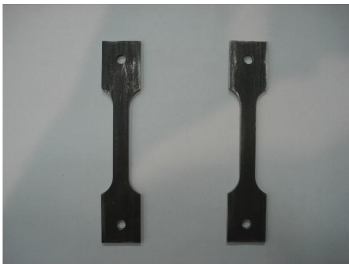
Figura 4.12 – Provete utilizado nos ensaios de tracção.
