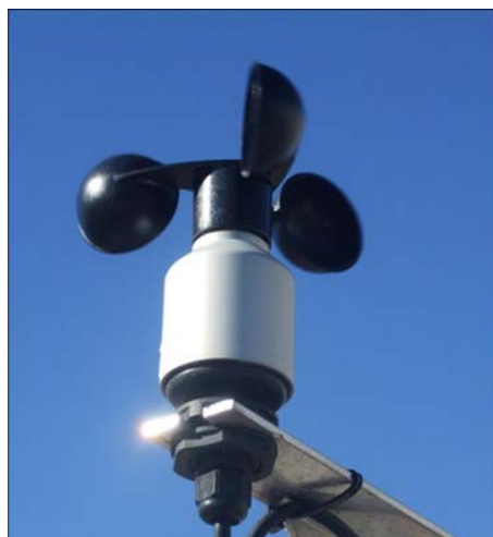
Fig.19 – Anemômetro – Medição da velocidade e/ou força do vento [14]
