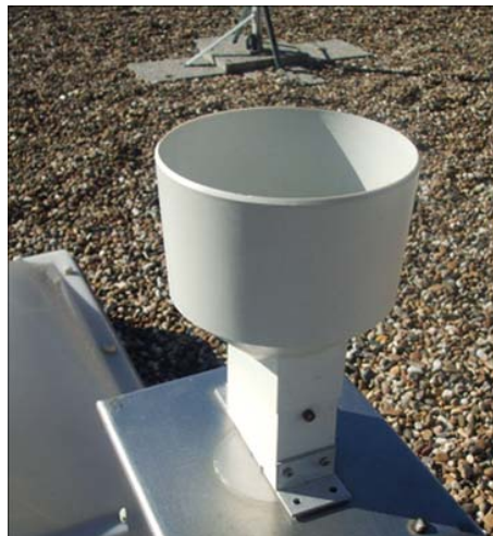
Fig.22 – Pluviómetro – Medição de precipitação [14]
