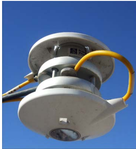
Fig.21 – Pirgeómetro – Medição de radiação terrestre e atmosférica [14]
