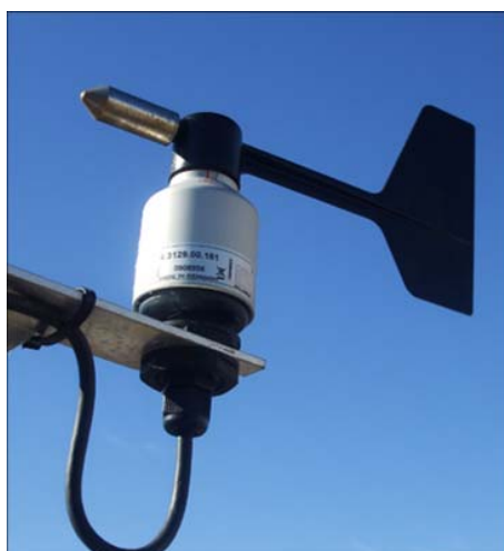
Fig.20 – Cata-vento – Medição da orientação do vento [14]
