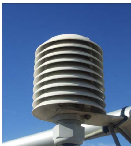
Fig.17 – Sensor de temperatura e humidade relativa [14]
