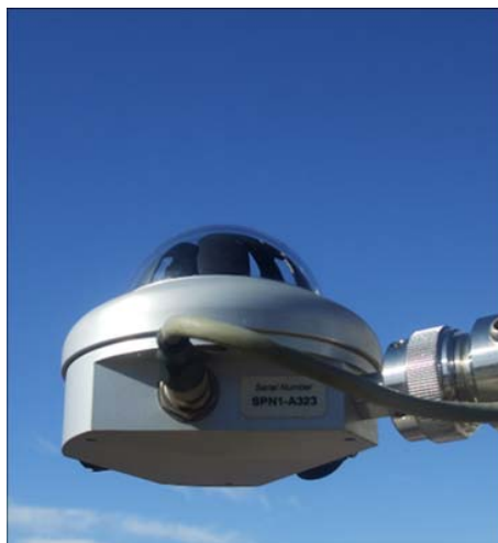
Fig.18 – Piranômetro – Medição de radiação solar [14]
